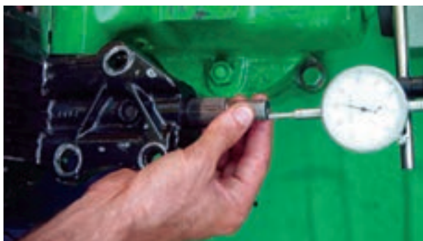
شکل ۷۰-۲- اندازه‌گیری لقی طول محور هزار خار
