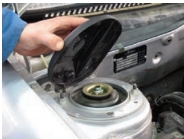
شکل ۳-۱۰۳- برداشتن پوشش بالای تکیه‌گاه کمک فنر
