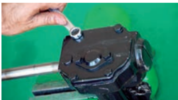
شکل ۲-۶۲- باز کردن درپوش بالایی جعبه فرمان
