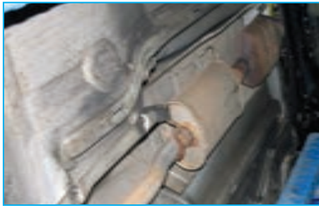
شکل ۱-۵۱- سپر حرارتی آگزوز
