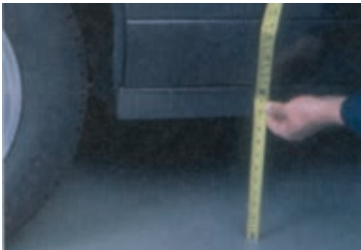
شکل ۳-۲۰۱- ارتفاع سیستم تعلیق (خودرو)
