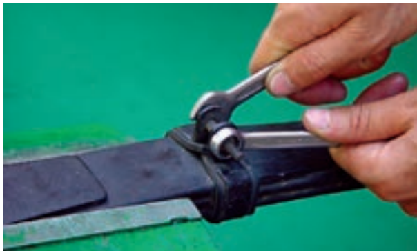
شکل ۳-۶۷- باز کردن بست‌های مجموعه فنر شمش
