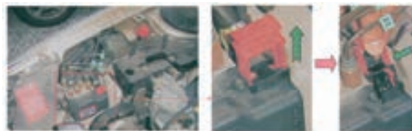
شکل ۱۶۶-۱- کنترل اتصالات الکتریکی سیم ترمز ضدقفل (ABS)
