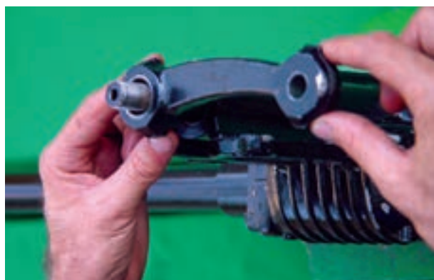
شکل ۲-۵۹- پیاده کردن اهرم هزار خار
