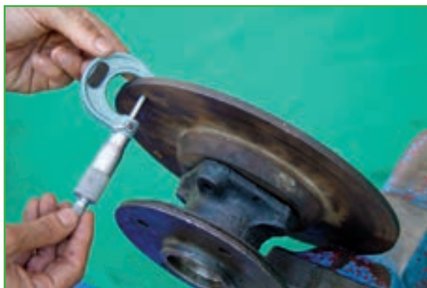
شکل ۱-۱۲۴- اندازه‌گیری ضخامت دیسک
