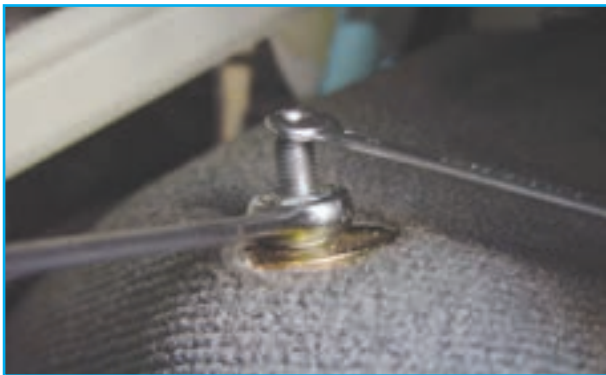
شکل ۳-۶۳- باز کردن مهره اتصال بالای کمک فنر
