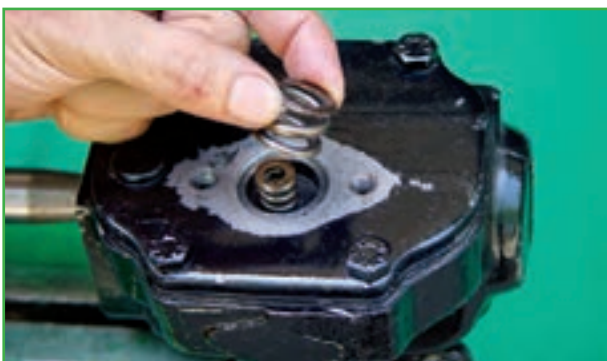
شکل ۲-۶۱- خارج کردن فنرها
