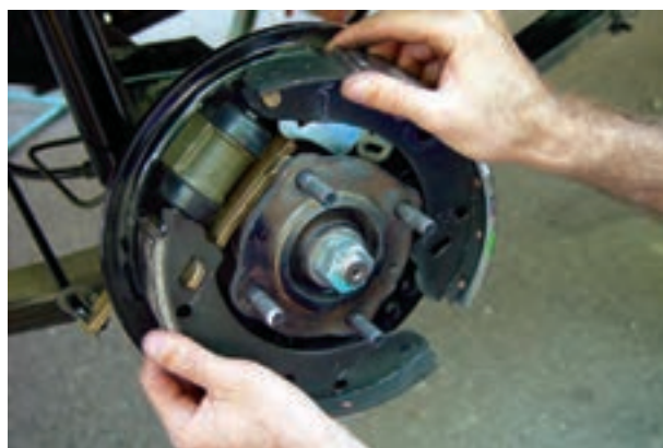
شکل ۱۰۴-۱- خارج کردن کفشک‌ها
