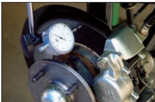
شکل ۱-۱۲۳- بررسی وضعیت دیسک
