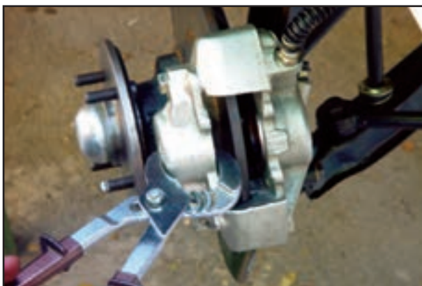
شکل ۱۱۴-۱- عقب راندن پیستون ترمز دیسکی
