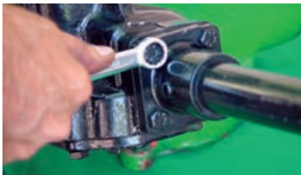
شکل ۲-۶۰- باز کردن پیچ‌های لوله فرمان
