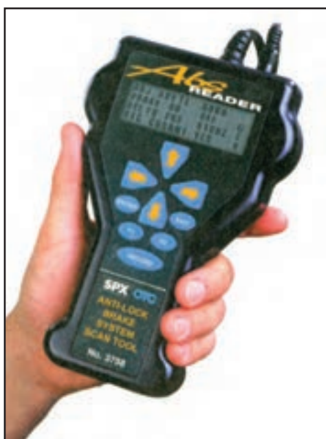
شکل ۱۶۵-۱- نوعی عیب‌یاب پرتابل
