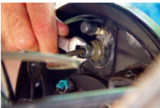
شکل ۱۰۵-۱- باز کردن مهره اتصال لوله ترمز
