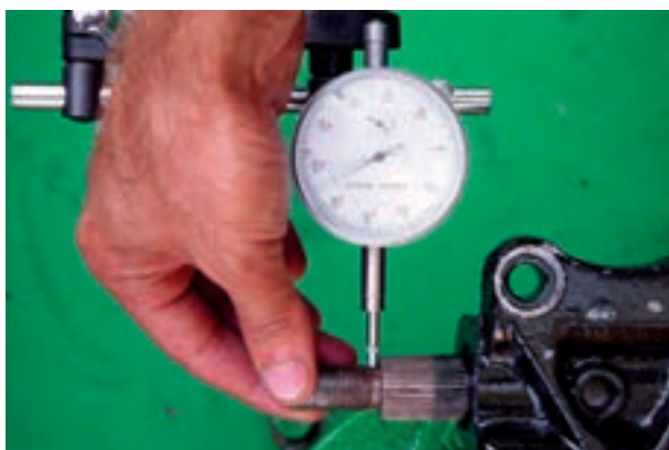
شکل ۷۱-۲- اندازه‌گیری لقی جانبی محور هزار خار
