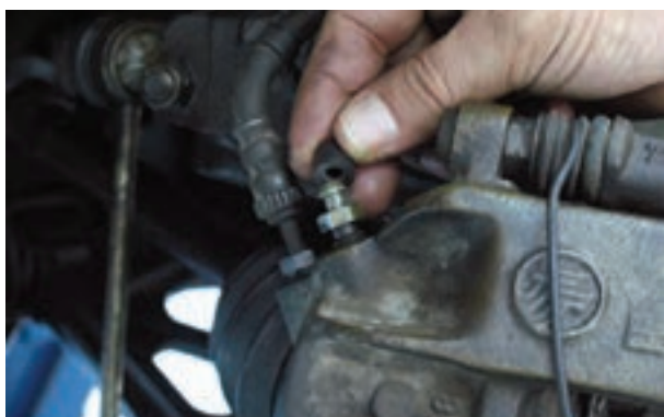
شکل ۱-۷۰- پاک کردن اطراف پیچ هواگیری
