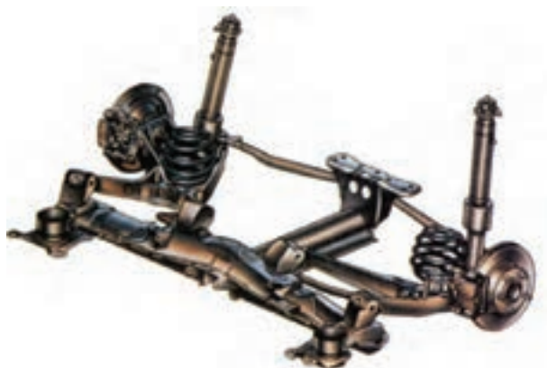
شکل ۳-۴۸- سیستم تعلیق مستقل عقب با چرخ‌های متحرک
