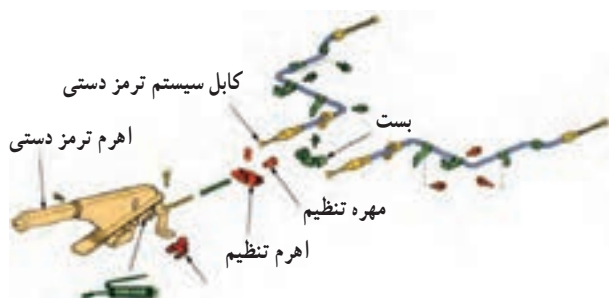
شکل ۱-۴۶-ا- اجزای سیستم ترمز دستی
