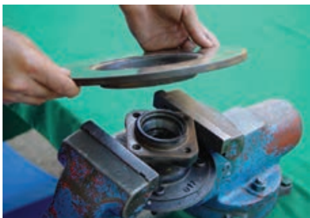
شکل ۳-۹۸- جدا کردن دیسک ترمز از تویی چرخ
