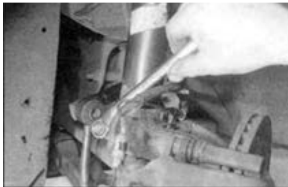
شکل ۱۱۸-۳- بستن پیچ نگه‌دارنده کمک فنر
