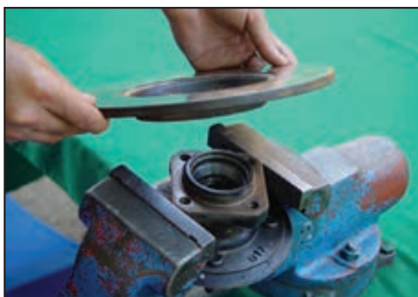
شکل ۱-۱۲۶- بازکردن دیسک ترمز
