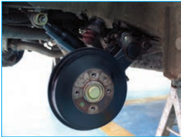
شکل ۱۸۳-۳- نصب ژامبون و متعلقات چرخ عقب
