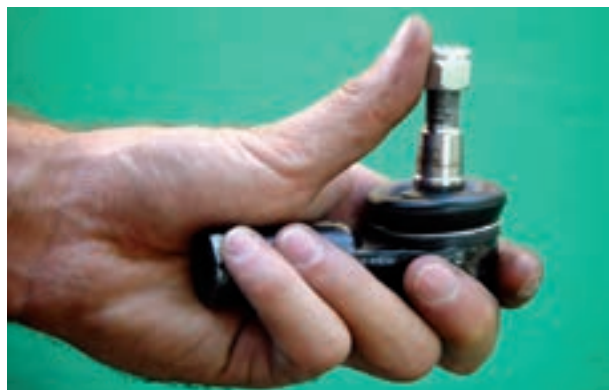
شکل ۸۴-۲- کنترل لقی سیبک‌ها
