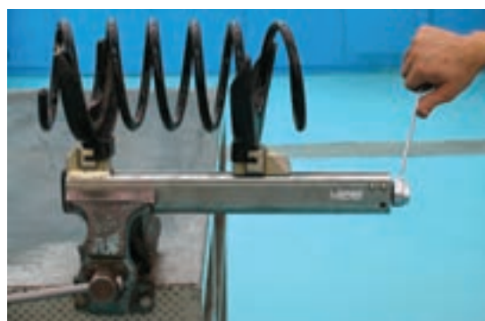
شکل ۳-۱۰۹ – نصب جمع‌کننده فنر روی گیره و کمک فنر روی آن
