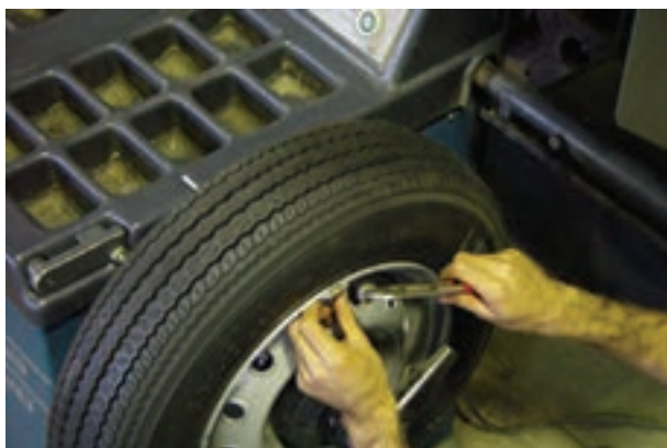
شکل ۲۳۸-۳- نصب وزنه روی قسمت بیرونی رینگ
