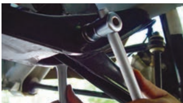
شکل ۳-۸۳- باز کردن طبق از رام
