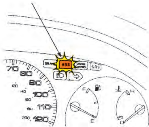
شکل ۱-۱۶۱- چراغ اخطار ترمز ضد قفل (ABS)
