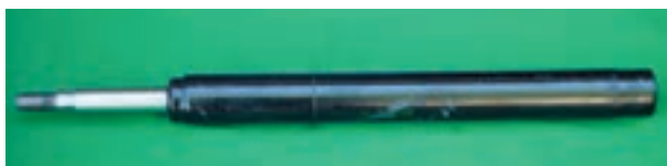
شکل ۳-۹۲- کمک فنر قابل تعویض
