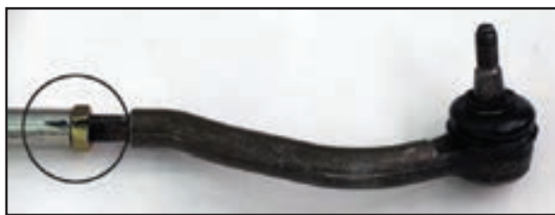
شکل ۲-۷۴- علامت گذاری سبیک و میل رابط
