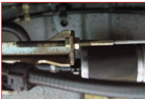
شکل ۴۸-۱- باز کردن مهره تنظیم کننده
