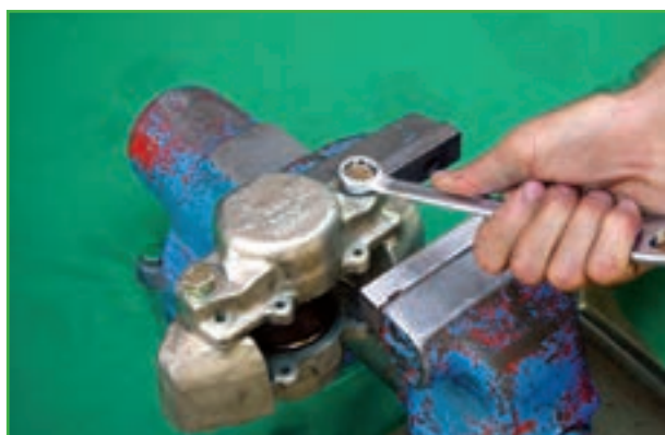
شکل ۱۲۰-۱ باز کردن پیچ های کالیپر
