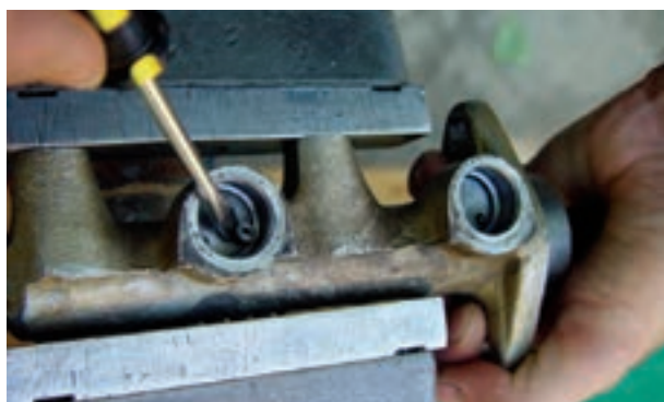
شکل ۱۳۱-۱ بستن سیلندر اصلی به گیره
