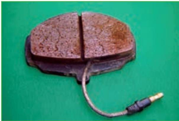
شکل ۱۱۲-۱- لنت ترمز دارای سیم هشدار
