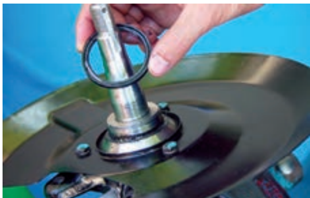
شکل ۳-۹۵- خارج کردن کاسه نمد پشت توپی چرخ
