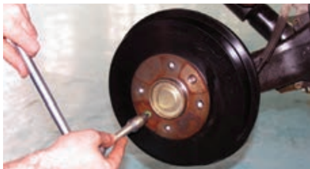
شکل ۱-۸۹ – باز کردن پیچ کاسه چرخ
