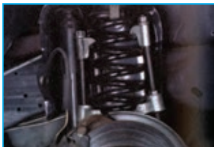
ب – ابزار مخصوص جمع کردن فنر ماریج (فنر جمع‌کن) دستی
