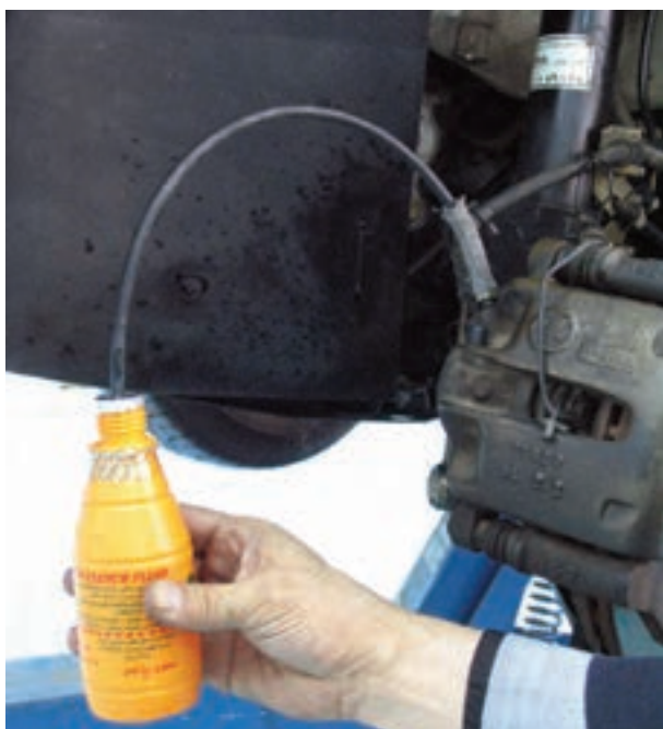
شکل ۱-۷۱- نصب لوله پلاستیکی روی پیچ هواگیری
