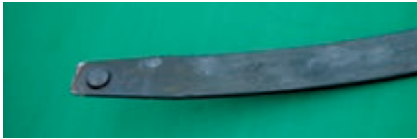
شکل ۷۰-۳- لاستیک‌های محافظ انتهایی لایه‌های فنر شمش
