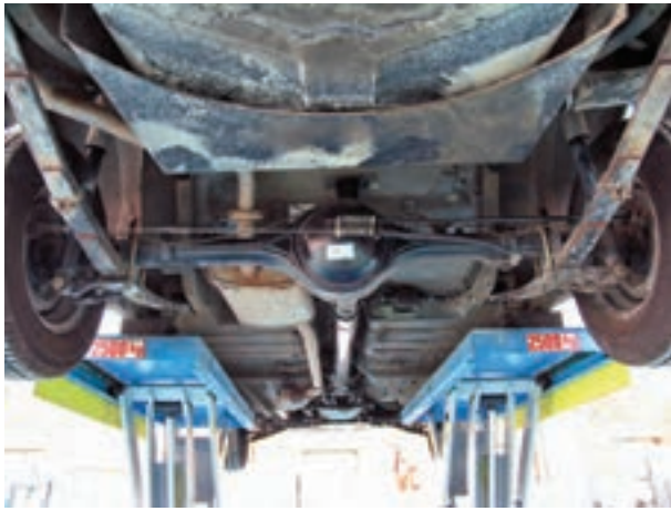
شکل ۳۱۵- دیفرانسیل در خودرو محرک عقب
