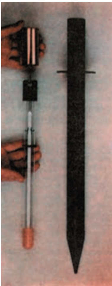
شکل ۲-۲- دماسنج برای اندازه‌گیری درجه حرارت خاک
