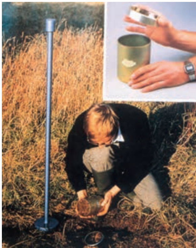
شکل ۱۶- ۱ نمونه برداری از خاک با سیلندر
