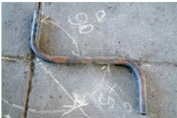
شکل ۳-۴۱- عدم دویدگی لوله‌ی دو خم
