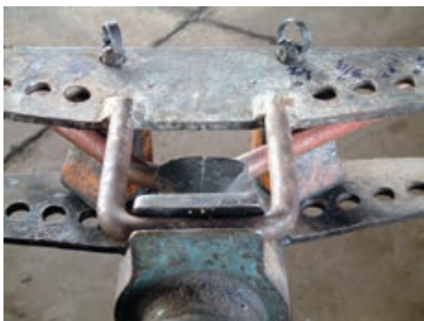
ب- باز کردن خم لوله‌ی خم شده
