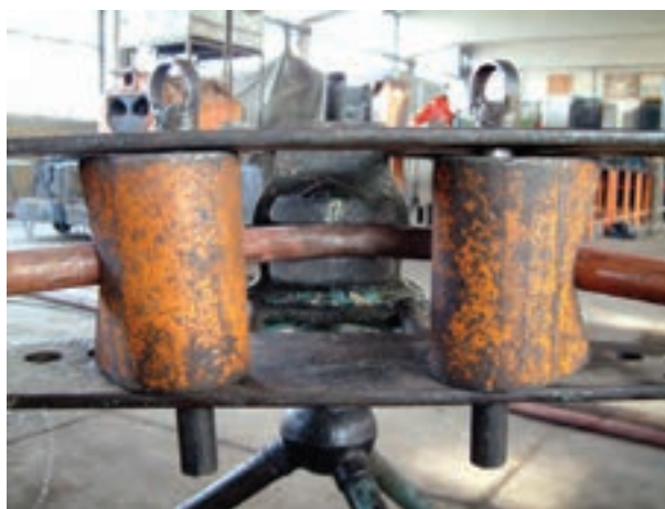
الف- باز کردن خم لوله‌ی خم شده
