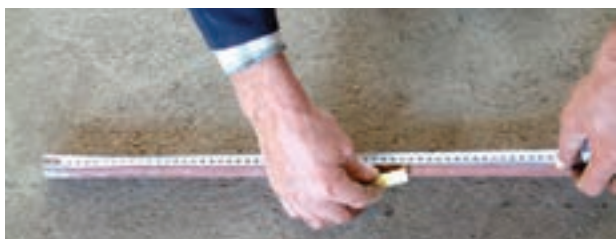
شکل ۳-۵۴- خط کشی لوله و تعیین محل‌های خم
