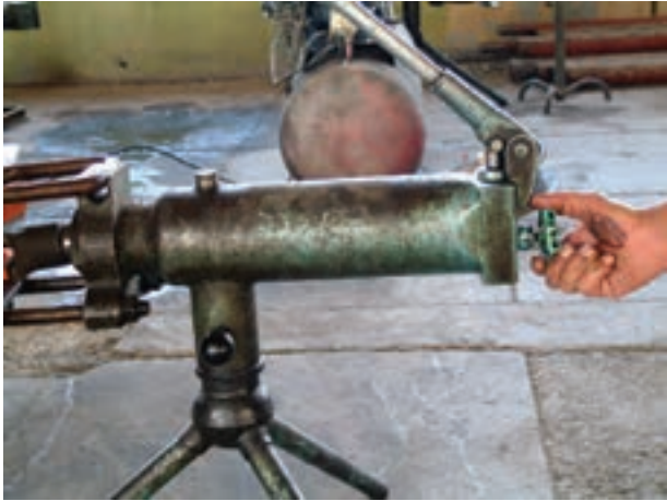
شکل ۳-۵۶- قرار دادن لوله در خم کن و بستن شیر قطع و وصل خم کن
