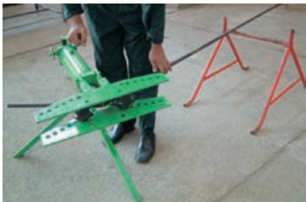
شکل ۳-۴۲- استفاده از خرک در خم کاری
