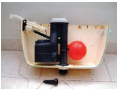
شکل ۲۳۴-۳- یک مخزن فشاری برش خورده با لوازم کامل آن
