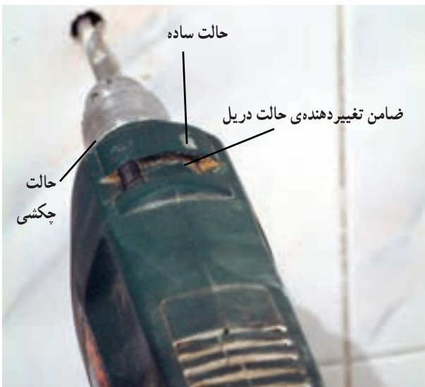
شکل ۲۱۲-۳ سوراخ کردن محل علامت‌گذاری شده
