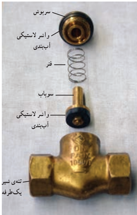
شکل ۲-۱۰۱- اجزای شیر یک طرفه‌ی سوپایی
