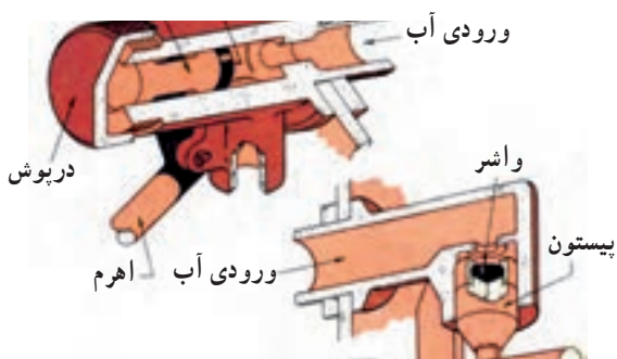
شکل ۱۱۳-۲ اجزای شیر شناور
