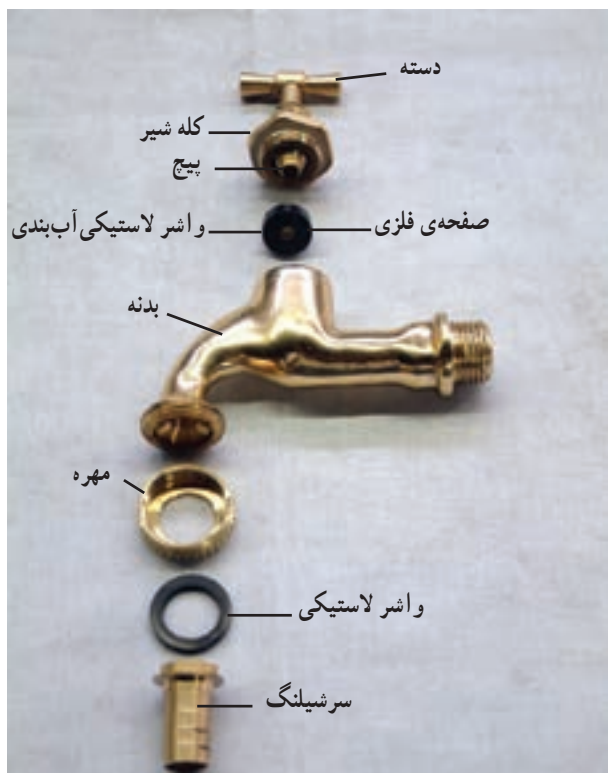
شکل ۱۲-۲- ب — اجزای شیر برنجی سرشیلنگی
