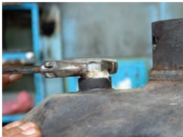
شکل ۱-۲۴- نحوه‌ی بازکردن میله‌ی منیزیم از محل خود
