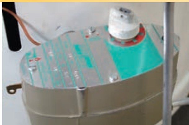
شکل ۱-۵۲- قرار دادن کلید گردان در حالت خاموش
