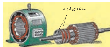
شکل ۴۶- اجزای موتور روتور سیم پیچی
