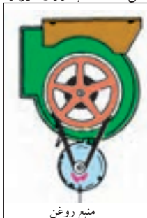
شکل ۹۸- نصب از سقف
