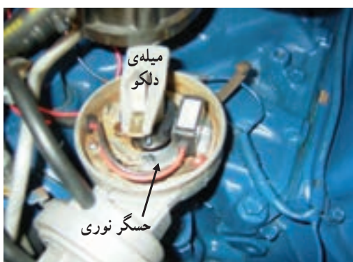
شکل ۱۴۵-۲- سه نمونه حسگر استفاده‌شده در سیستم جرقه‌زنی
