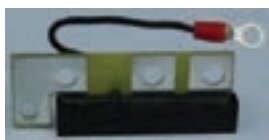
دیودهای مورد استفاده در آلترناتور خودرو
