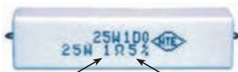
تولرانس 5\% درصد مقدار مقاومت یک اهم
