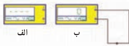
شکل ۲-۷۹ - آزمایش اطمینان از سلامت اهم متر
