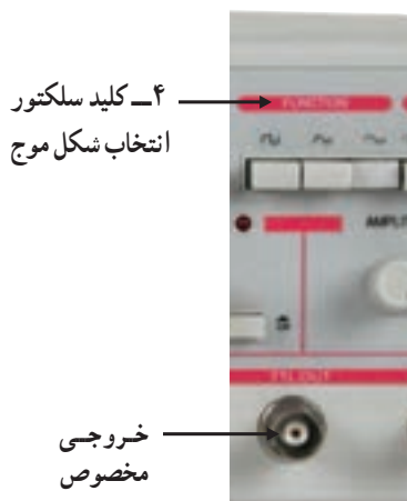
شکل ۱۰۱-۲ کلید سلکتور انتخاب شکل موج
