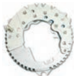
دیودهای مورد استفاده در آلترناتور خودرو
