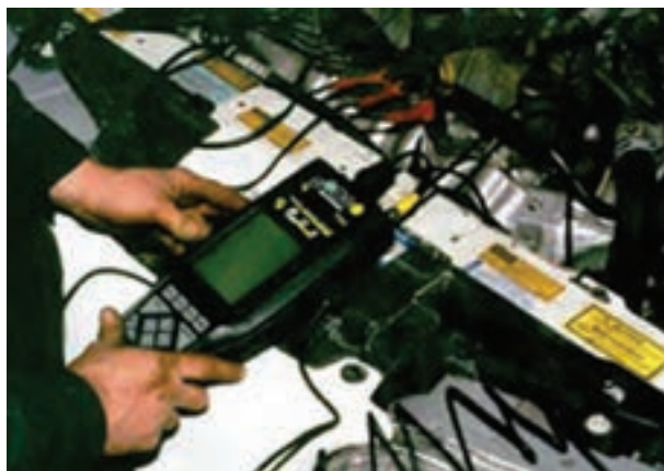
شکل ۱۹۴-۲- یک نمونه دستگاه اسکنر کوچک دستی
