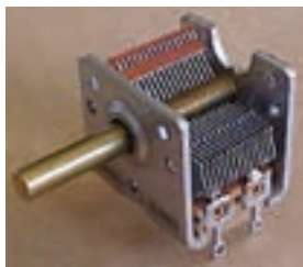
خازن متغیر قابل تنظیم با محور
