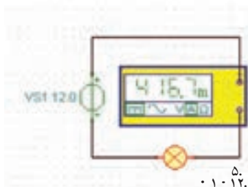
شکل ۹۴-۲ اندازه گیری جریان یک لامپ ۱۲ ولتی ۰.۵ وات
