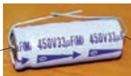
الف - توجه به قطب‌های خازن الکترولیتی
