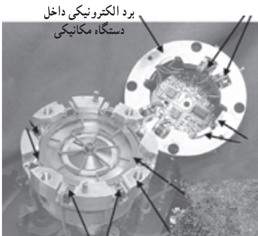
شکل ۱۹۱-۲ یک نمونه برد الکترونیکی که در داخل قسمت‌های مکانیکی نصب شده است
