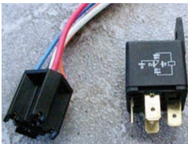
شکل ۷-۱۳- یک نوع رله یا آفتامات بوق
