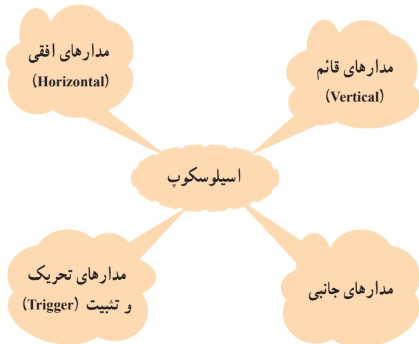
شکل ۱۲۰-۲- مدارهای موجود در اسیلوسکوپ
