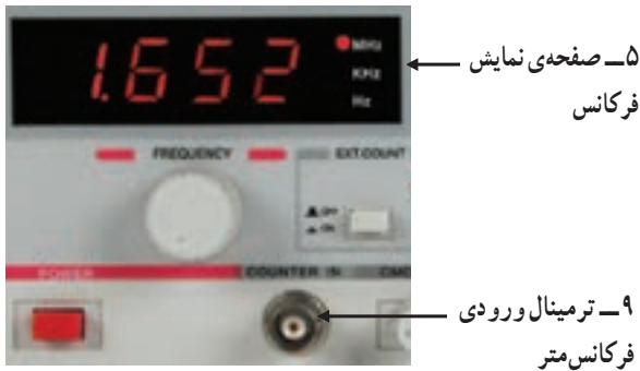
شکل ۱۰۳-۲ فرکانس متر و ترمینال ورودی آن
