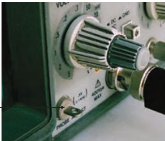
شکل ۱۱۶-۲- این ترمینال روی اسیلوسکوپ قرار دارد و سیگنال مربعی با دامنه‌ی ۵/۰ تا یک ولت و فرکانس یک کیلوهرتز تولید می‌کند.
