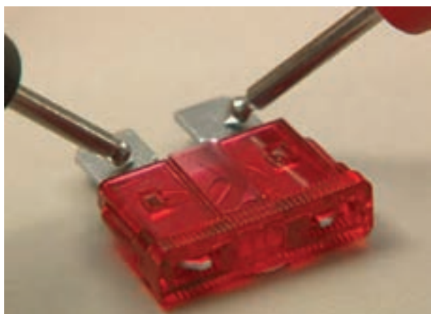
شکل ۸۱-۲ اتصال فیوز به اهم متر
