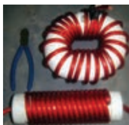
سلف پیچیده شده روی قرقره بدون هسته
