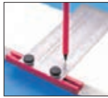
شکل ۱-۳۴ قرقره‌های متصل کننده‌ی خط کش به میز
