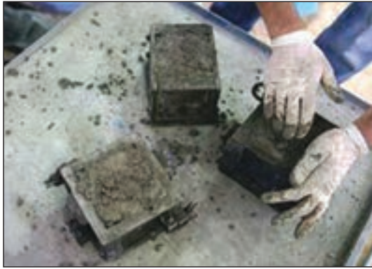
شکل ۱-۵۱ آزمایش مقاومت بتن
