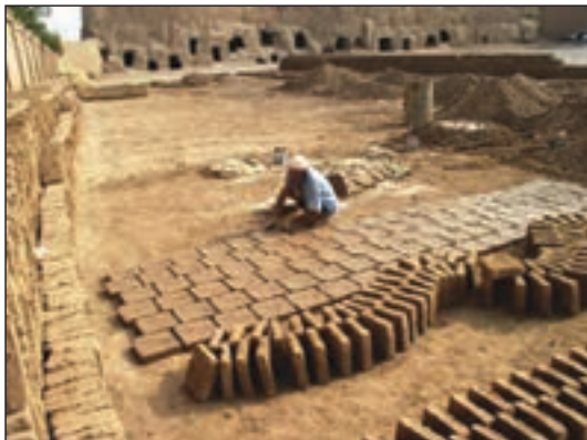
شکل ۱-۵۴ خشت خام (ساخت آجر به روش دستی)
