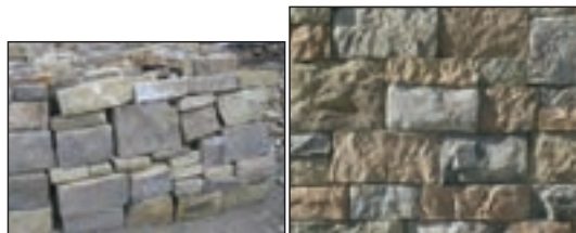
شکل ۱۴۵- سنگ بادبُر سر تراش
