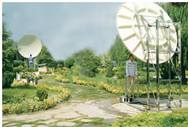
شکل ۳-۳۵ الف) دو سطح بازتابنده کاو در یک پارک تفریحی و ب) طرحی از بازتاب امواج صوتی از دو سطح کاو مقابل هم با استفاده از نمودار پرتویی
