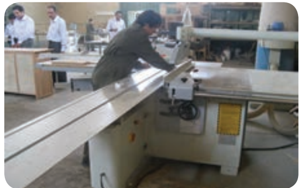
شکل ۴۸-۵- تنظیم گونیا پست اره دور کن
