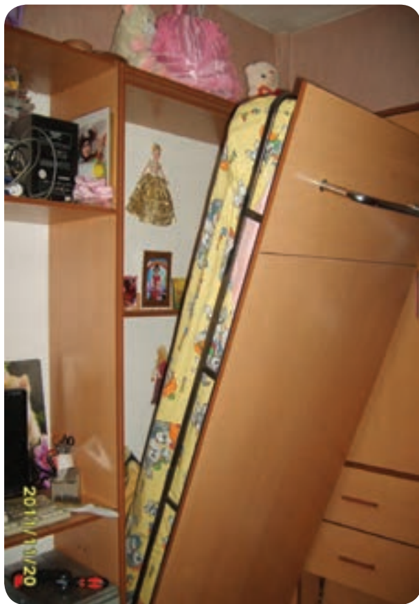
شکل ۱۸۴-۵- کنترل تعادل تختخواب به وسیله جک‌ها
