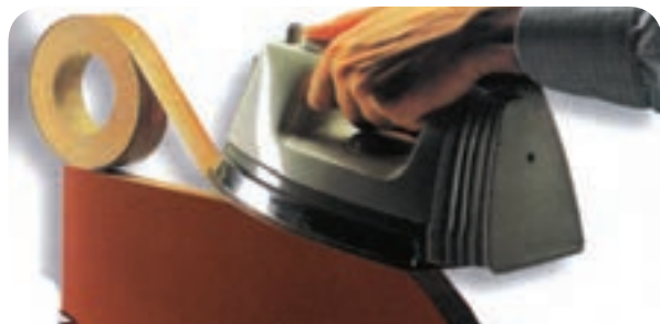
شکل ۴-۱۶ - نوار کردن لبه‌های قوس‌دار توسط اتو
