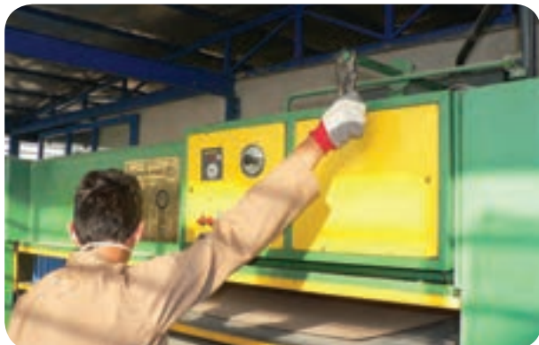
شکل ۹۵-۵- اهرم باز کردن صفحات پرس
