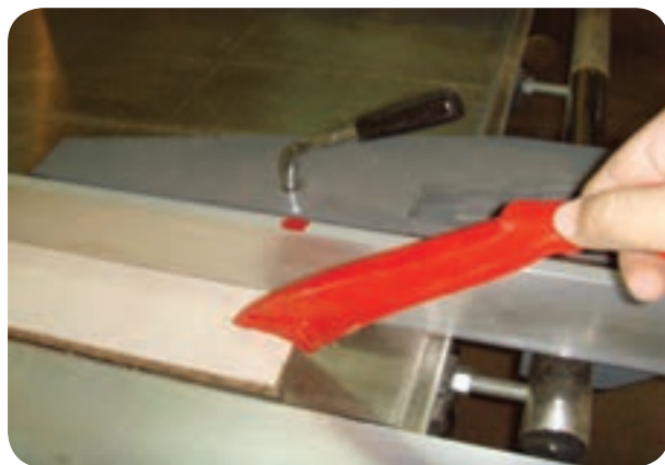
شکل ۵-۶۵- استفاده از وسیله کمکی هدایت قطعه باریک
