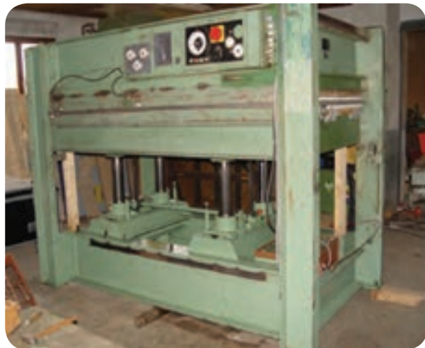
شکل ۷۴-۵ پرس گرم الممتی دو طبقه هیدرولیکی
