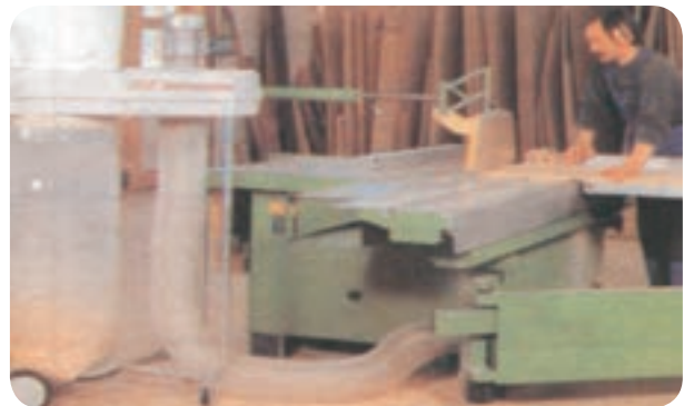
شکل ۵-۲۵- استفاده از حفاظ و تجهیزات ایمنی
