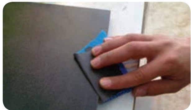
شکل ۴-۳۰ - پرداخت لبه لبه‌های نوار شده با سنباده
