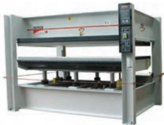
شکل ۹۷-۵- بندهای قطع اضطراری برق پرس در اطراف آن
