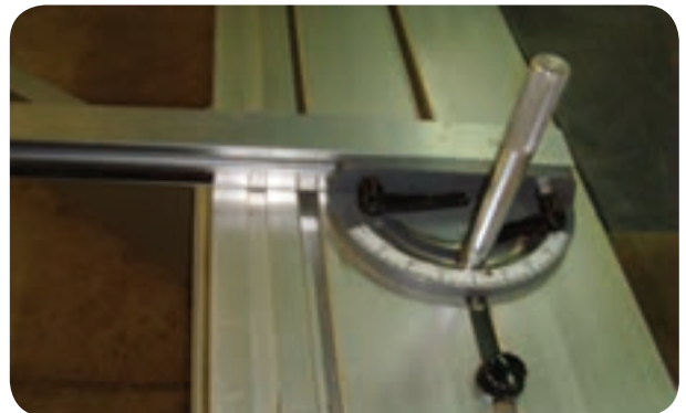
شکل ۵-۵۲- گونیای کوچک قابل تنظیم برای برشکاری
