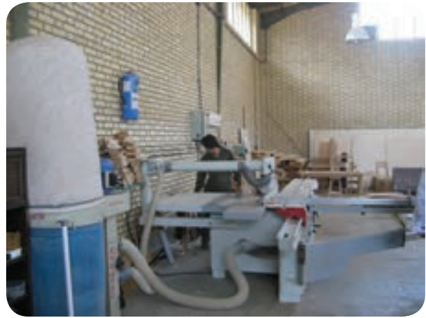
شکل ۵-۵۹- مکنده مناسب ماشین دورکن
