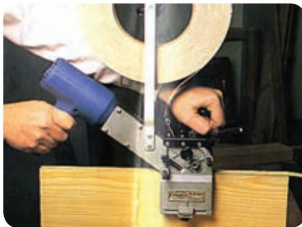
شکل ۴-۱۹ - نحوه نوار کردن با سشوار
