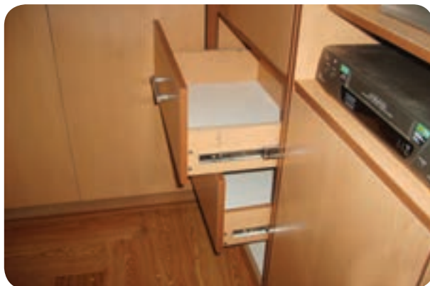
شکل ۱۷۷-۵- نصب کشویی تلسکوپی سه ریله برای کشو
