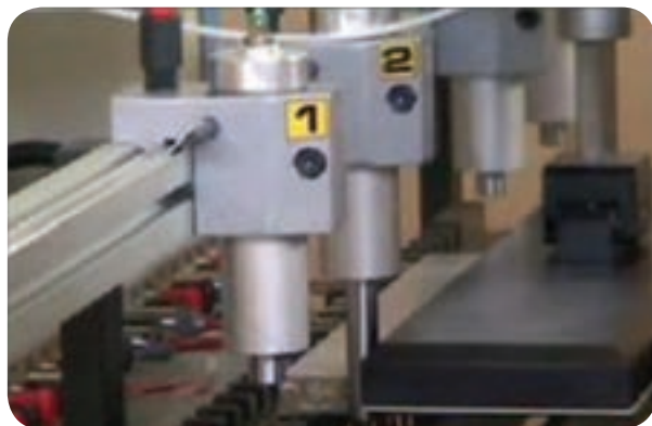
شکل ۳-۷ - قطعه کار، توسط جک‌ها گونیا شده است.
