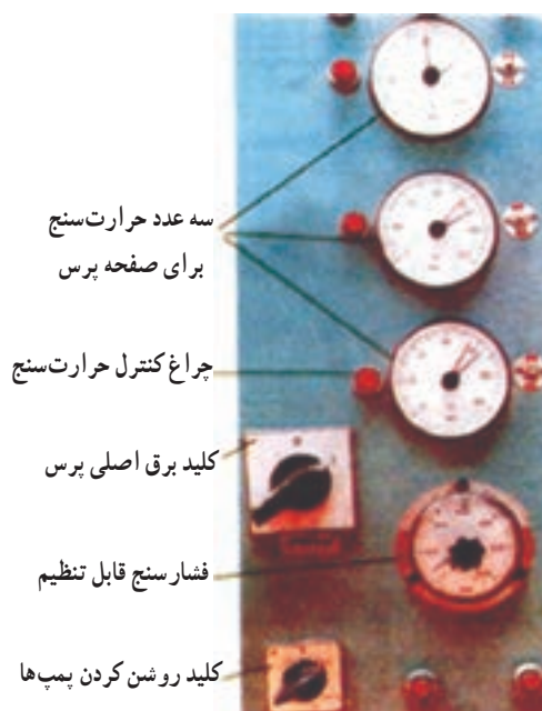
شکل ۸۷-۵- تنظیم اجزای پرس برای چسباندن روکش
