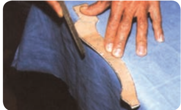
شکل ۵-۲۱- تهیه شابلن خط‌کشی برای ساخت پایه
