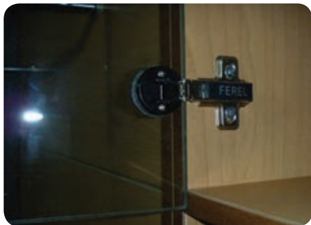
شکل ۱۴۳-۵- نصب لولای شیشه‌ای گازی برای در شیشه‌ای ویتربین
