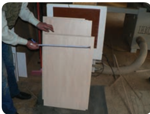
شکل ۱۱۶-۵- کنترل اندازه قطعات آماده شده
