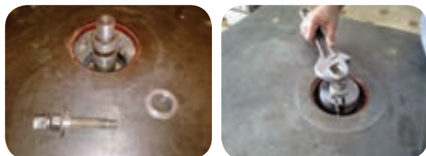
شکل ۲۸-۲- تنظیم کردن تویی در دستگاه فرز
