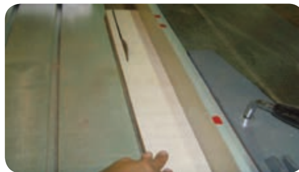
شکل ۱۰۴-۵- خطر پس‌زدن و پرتاب قطعه وجود دارد
