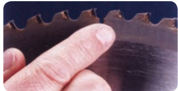
شکل ۵-۴۲ دندانه های اره شکسته یا کند شده
