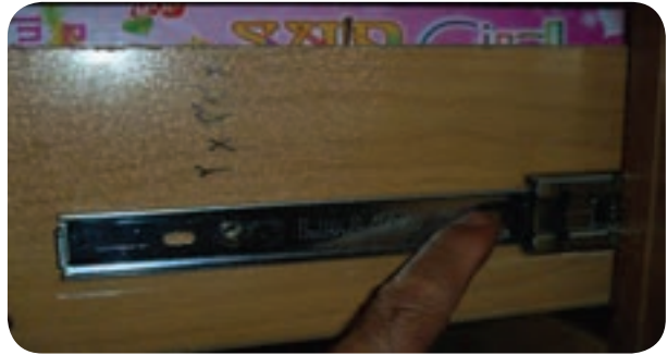
شکل ۱۵۸-۵- ضامن قفل و آزاد کردن کشو باریل تلسکوپی
