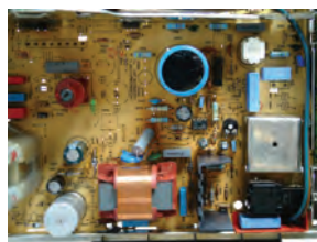
شکل ۶۲-۱- مدار کامل منبع تغذیه همراه با شکل قطعات و برد مدار چاپی آن
