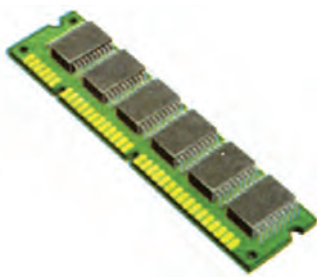
شکل ۲-۹۹- آی سی های RAM در یک کامپیوتر
