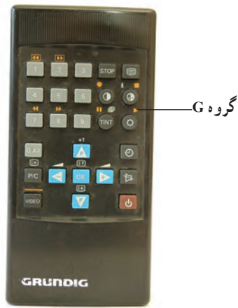
شکل ۲۷-۳. کلیدهای گروه G روی دستگاه کنترل از راه دور
