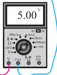
شکل ۱۷۸-۱- آ سی کنترل و ولتاژ پایه ۲۰
