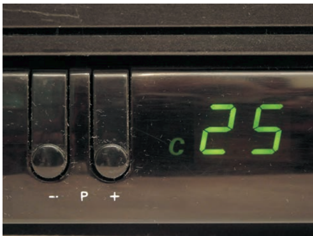
شکل ۲۸-۳. با فشردن P/C علامت C در کنار نشانگر روشن می‌شود.
