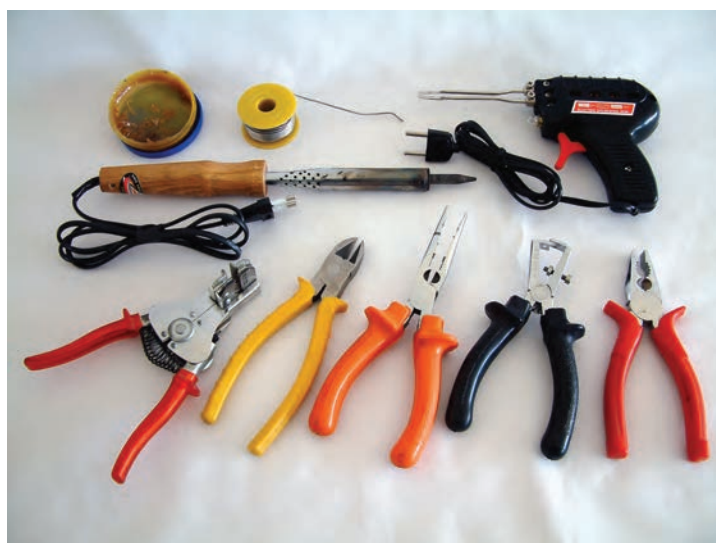
شکل ۹۱-۲- برخی ابزار کارگاه الکترونیک
