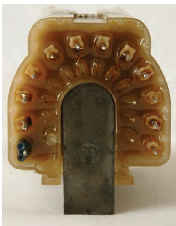
شکل ۱۳۴-۱- شکل پایه‌های TR526
