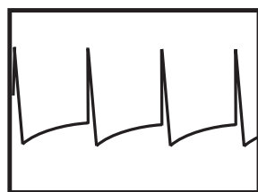
شکل ۱-۱۰۲- ولتاژ L' از ترانس سطر
