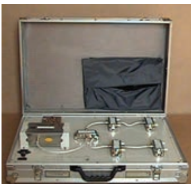
شکل ۱-۷۳- نمونه‌ای از سیمولاتور آنتن مرکزی
