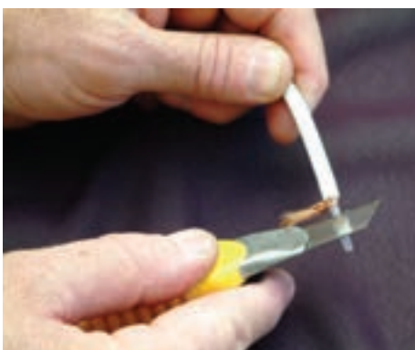
شکل ۱-۶۱- در بریدن کابل باید دقت شود.
