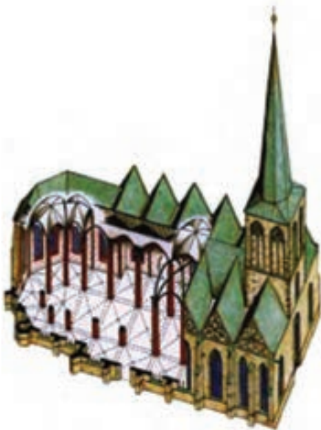
تصویر ۹- طرح کلی یک کلیسای گوتیک
