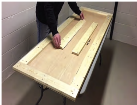
شکل ۴۲- نوارهای چوبی لبه تخته با فیتینگ‌های نصب
