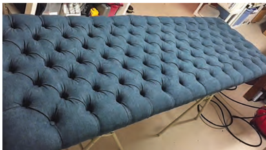
شکل ۷۱- لمسه کاری کامل دیوارپوش تزئینی
