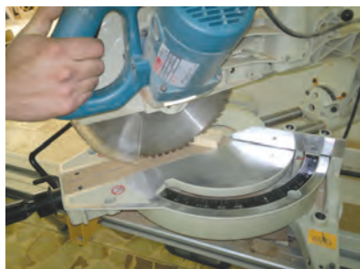
شکل ۲۰- برش فارسی یا ۴۵ درجه باره فارسی بر
