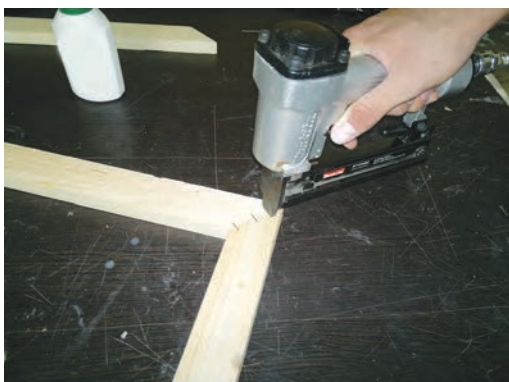
شکل ۲۶-زدن ۲ یا ۳ منگنه در گوشه قاب
