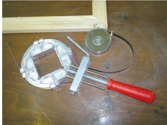
شکل ۲۹- گیره تسمه‌ای مخصوص قاب
