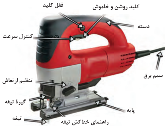
شکل ۴۰- قسمت‌های مختلف اره عمودبر
