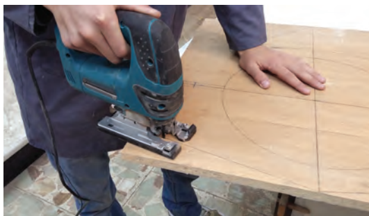
شکل ۵۲- برش حاشیه مورب پایه‌ها
