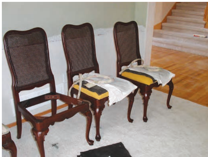
شکل ۶۸- مراحل رویه کوبی کف صندلی
