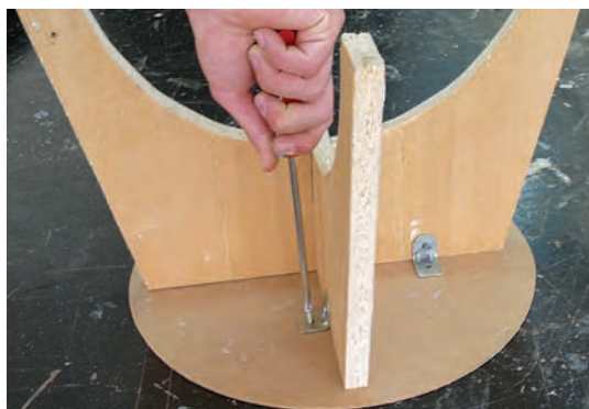
شکل ۶۷- مراحل مونتاژ چهارپایه
