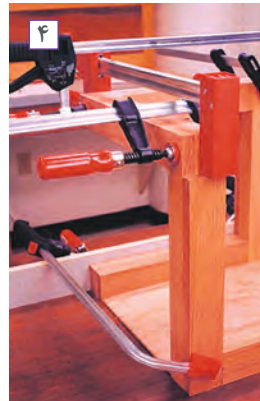
شکل ۲۷- مراحل مونتاژ میز جلوی مبل
