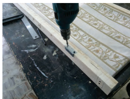
شکل ۷۱- بستن پیچ دوم
