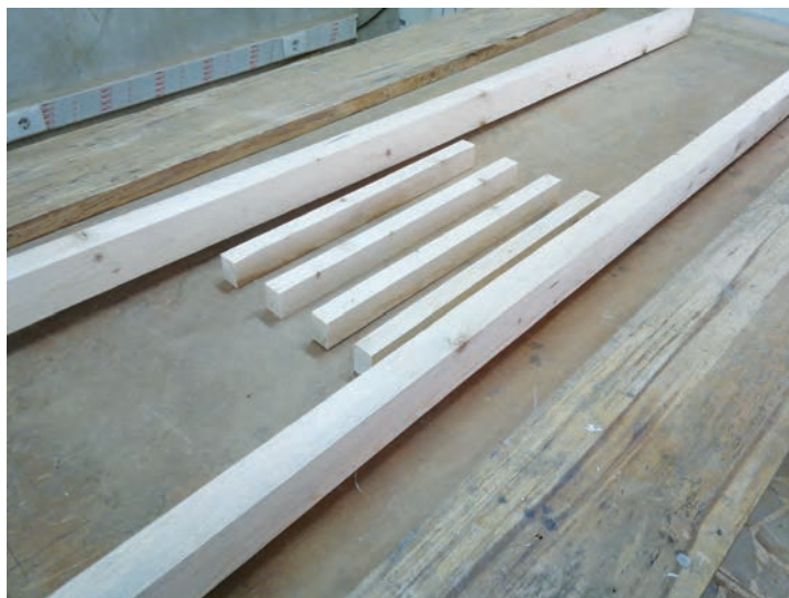
شکل ۳۹- قطعات پاراوان (۲ قید طولی و ۴ قید عرضی)
