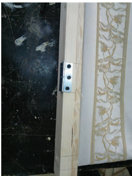
شکل ۷۲- محکم کردن برگه اول لولا با ۳ پیچ
