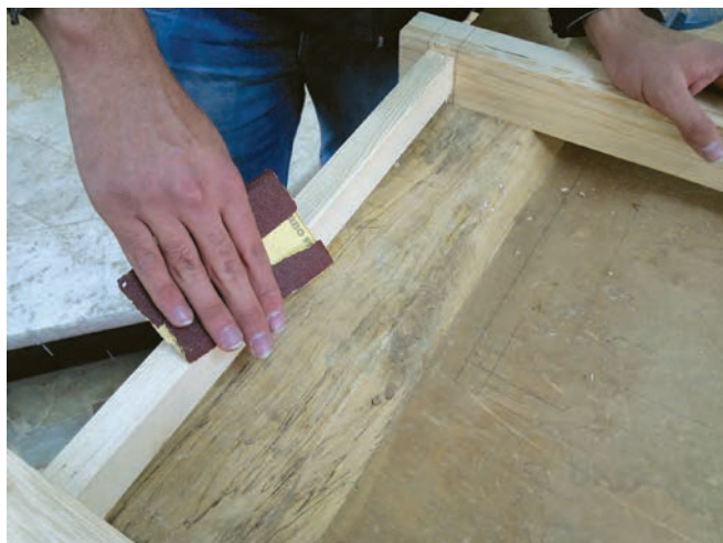
شکل ۶۰- سنباده زدن و گرفتن تیزی لبه‌ها
