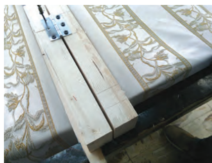
شکل ۷۴- بستن پیچ دوم برگه دوم لولا
