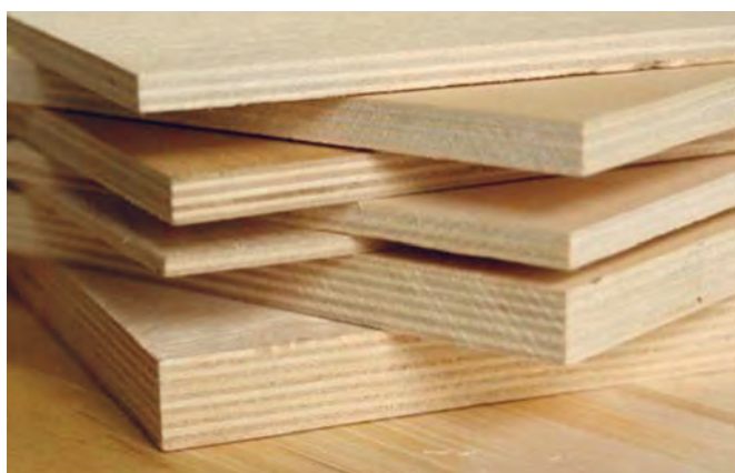
شکل ۲- انواع تخته چند لایه
