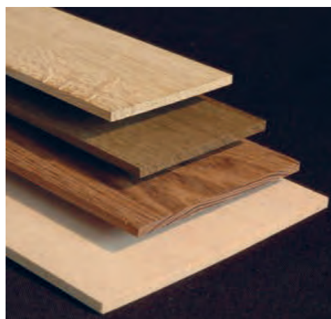
شکل ۳- انواع چوب فرآوری شده جهت کف سازی
