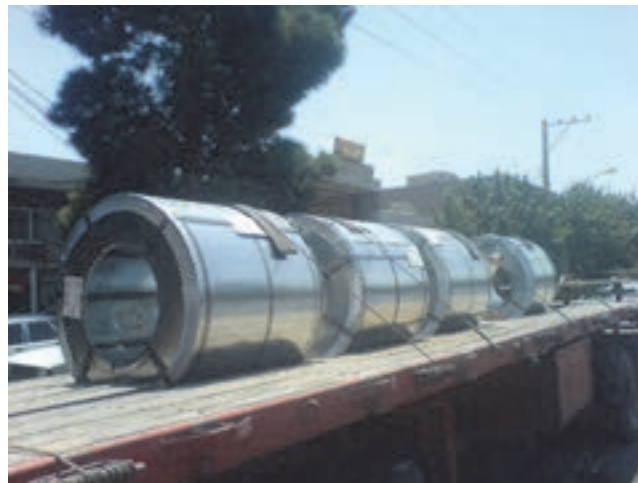
شکل ۴۲- نمونه‌ای از استقرار رول فلزی به صورت طولی با کمک جارولی
