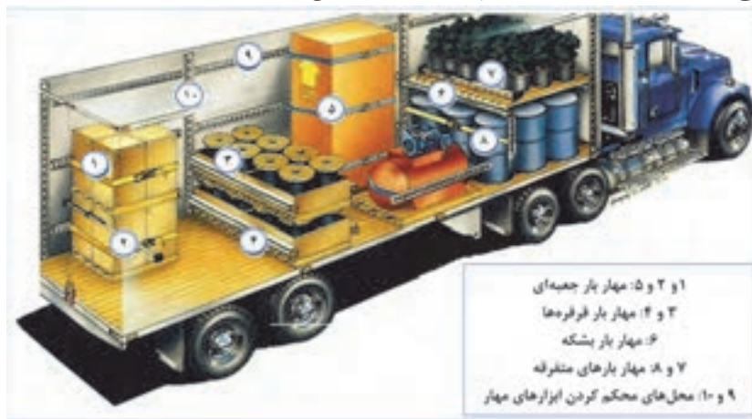
شکل ۱۲- نمونه‌هایی از مهار انواع بار در یک بارگیر
