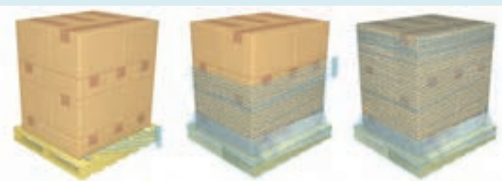
شکل الف- نحوه چیدمان و کشیدن نایلون روی پالت
