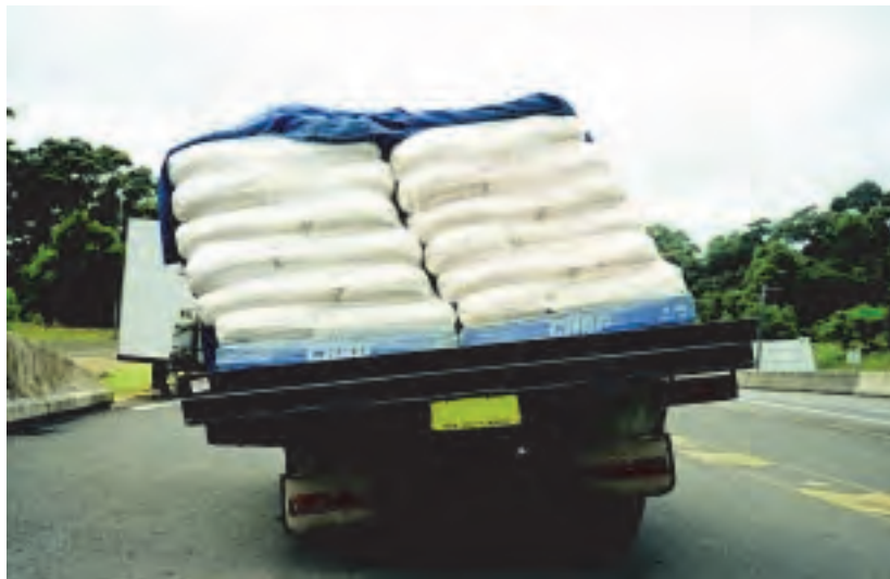
شکل ۳۲- عدم تعادل وسیله‌نقلیه به دلیل بارگیری نامناسب
