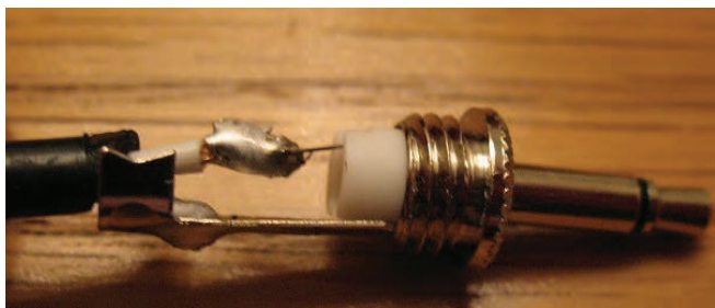
تصویر ۸۵- نقاط اتصال سیستم‌های نان سیمتریک
