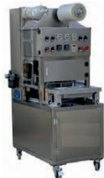
نمونه‌ای از دستگاه بسته‌بندی سیل و کیوم اتوماتیک با تزریق گاز
