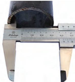
شکل ۴۸ - شاخک‌های داخل‌سنج کولیس
