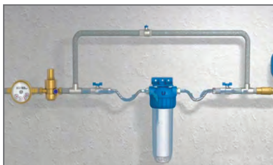
شکل ۶ - روش نصب سختی گیر پلی فسفات
