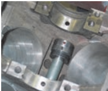
تعوّض بوش‌های میل سوپاپ
