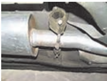
بررسی بست‌های نگهدارنده سیستم اگزوز
