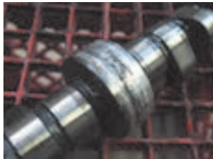
خرابی تکیه‌گاه میل سوپاپ
