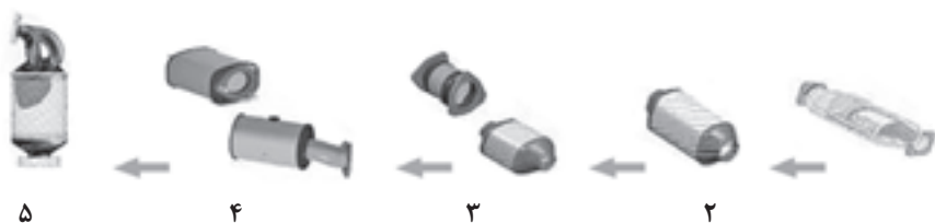
شکل ۱۲-۳ سیر تکاملی مبدل های کاتالیستی
