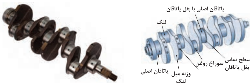
(ب) میل لنگ با یک وزنه در طرف مقابل لنگ
