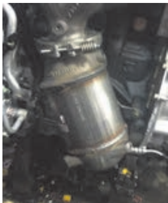
مجموعه مانیفولد خروجی و کاتالیست محل نصب مانیفولد خروجی و کاتالیست روی موتور خودرو شکل ۳-۵ مبدل کاتالیست یکپارچه
