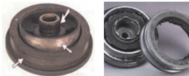
پاره شدن لاستیک میان دو حلقه
