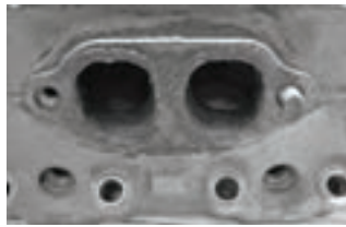
بریدن پیچ اتصال مانیفولد دود داخل سرسیلندر
