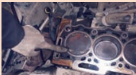
برخورد سوپاپ‌ها به سر پیستون
