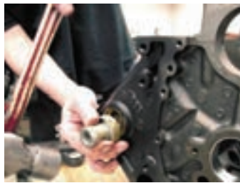
ابزار مخصوص و روش نصب پولکی
