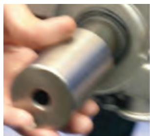
نصب کاسه نمدها با ابزار مخصوص
