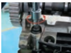
جهت باز کردن پیچ های سرسیلندر
