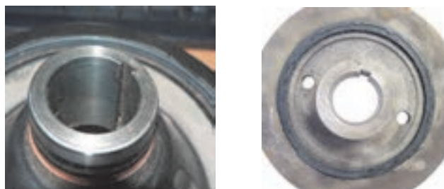
ساییده شدن محل قرارگیری کاسه نمد
