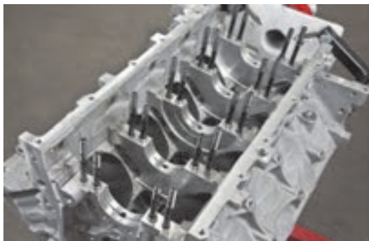
شکل ۲-۲۹ پیچ‌های اتصال کپه یاتاقان‌ها و محفظه لنگ
