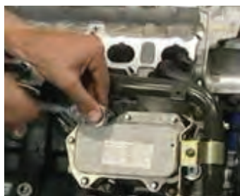
نصب خنک کن روغن بر روی موتور
