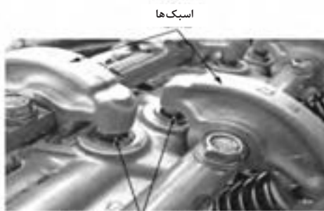
تنظیم کننده های لقی هیدرولیکی
