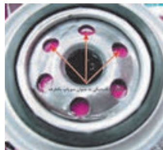
سوپاپ یک طرفه روغن
