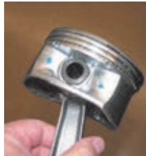
الف) اتصال پرسی شکل ۵۱-۲ ب) جای زدن گژن پین در داخل شاتون گرم شده
