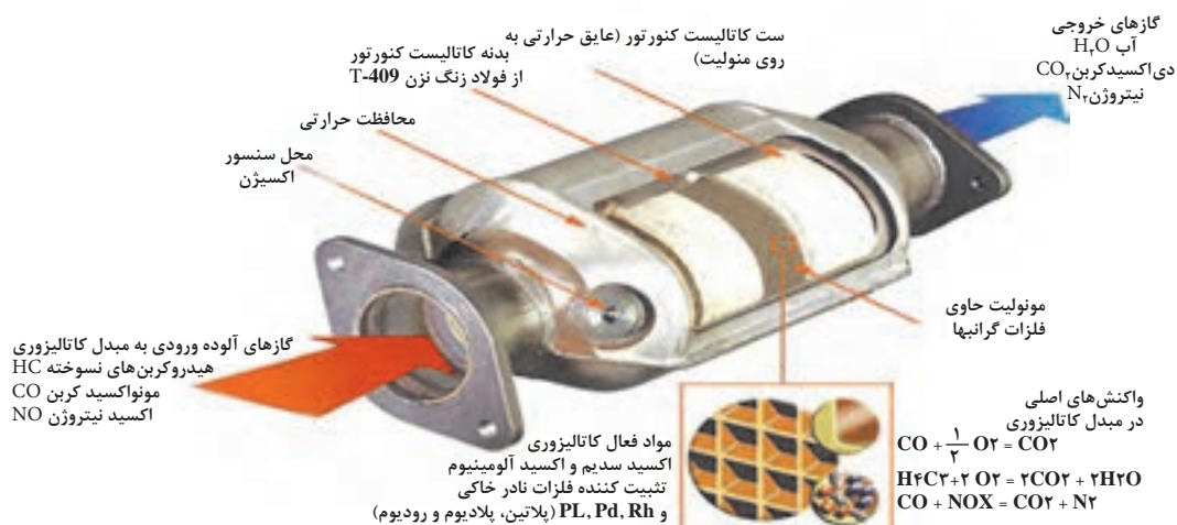
شکل ۱۱-۳ بخش های تشکیل دهنده یک مبدل کاتالیست
