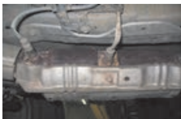
محل نصب حسگر اکسیژن روی مبدل کاتالیست
