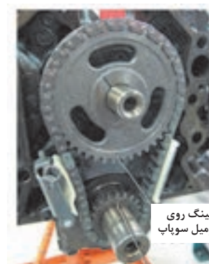
مکانیزم حرکتی زنجیری در موتور OHV
