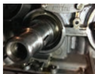
بازکردن چرخ دنده سر میل لنگ
