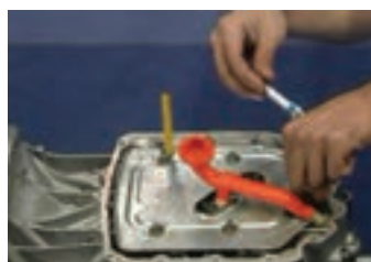
باز کردن صافی روغن ورودی به پمپ
