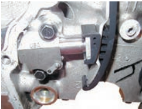
تجهیزات زنجیر سفت کن هیدرولیکی
