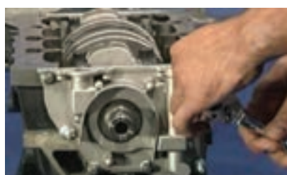
باز کردن پیچ های پمپ روغن
