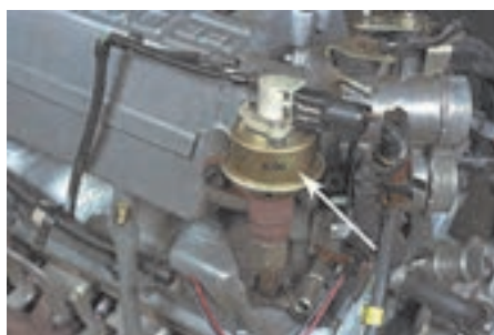
محل نصب EGR روی موتور خودرو
