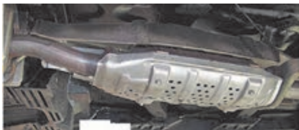
شکل ۲۷-۳ محل نصب سپر حرارتی در سیستم اگزوز
