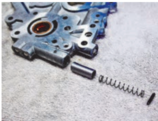
شکل ۴-۶ محل قرارگیری سوپاپ کنترل فشار
