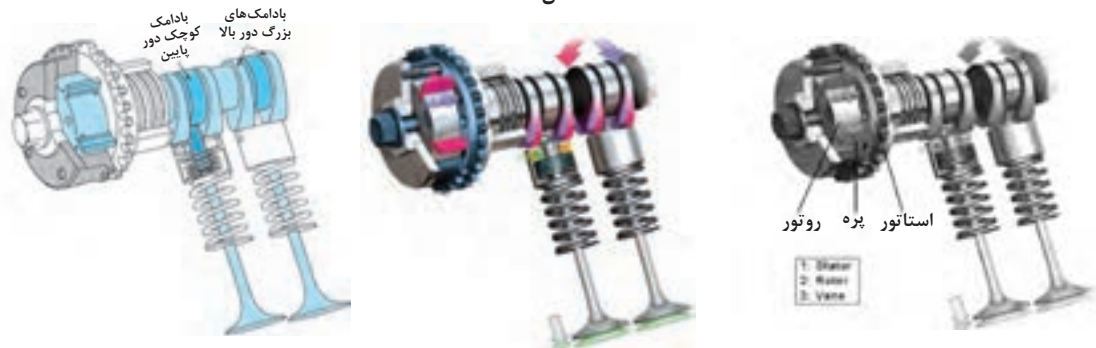
سرسیلندر با مکانیزم تایمینگ متغیر با تغییر ارتفاع باز شدن سوپاپ‌ها (نوع هیدرولیکی دارای بادامک ارتفاع کم و زیاد با پین قفل کننده اسبک‌ها) شکل ۶-۱
