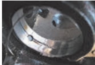
خرابی یاتاقان میل سوپاپ
