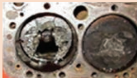
ذوب شدن پیستون
