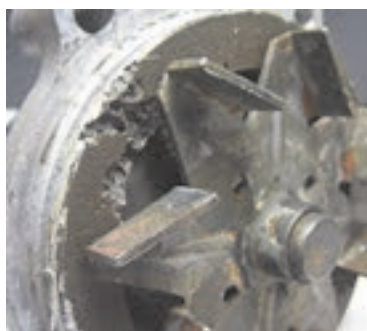
خرابی بلبرینگ و خوردگی داخلی
