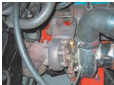
محل نصب توربو شارژر روی موتور
