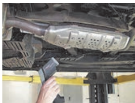
برای کنترل دمای کاتالیزور با استفاده از حرارت سنج آن، خودرو باید روی جک بالا بر، روشن و به دمای نرمال رسیده باشد.
