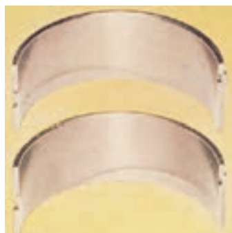
الف) سایش غیر یکنواخت یاتاقان
