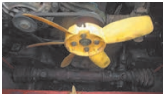
وجود شکستگی یا ترک پره ها
