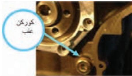
شکل ۳۰-۴ پیچ های کورکن مدار خنک کاری
