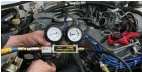
شکل ۸-۲۹- دستگاه نشستی سنج
