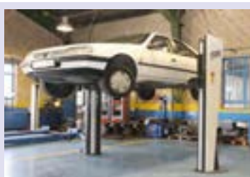
۲- پس از رسیدن موتور به دمای طبیعی آن را با رعایت ایمنی رو چاله سرویس و با جک بالا بر مستقر کنید.
