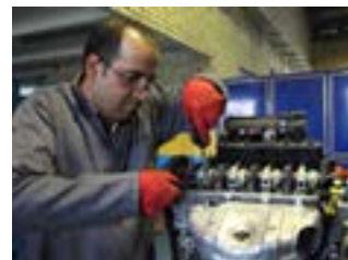
شکل ۳۳-۸- تنظیم پیچ و مهره‌ای خلاصی سوپاپ‌ها
