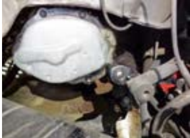
۲- پیچ ورودی روغن جعبه دنده باز شود.
