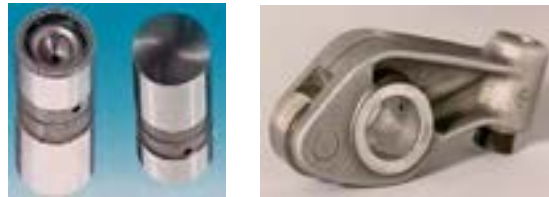
شکل ۸-۳۷ - دو نوع تنظیم‌کننده هیدرولیکی سوپاپ‌ها
