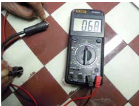
شکل ۴۳-۸- تست اهمی وایر شمع
