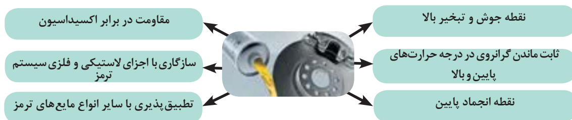
شکل ۲-۶- ویژگی‌های مایع هیدرولیک ترمز
