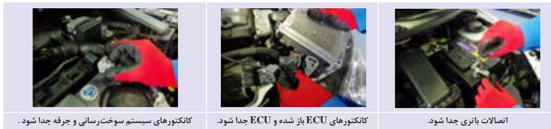
شکل ۷-۹ باز کردن قطعات و اتصالات الکتریکی از موتور
