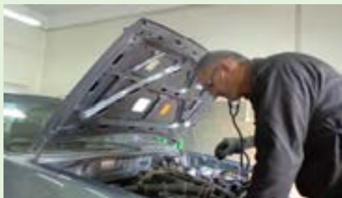
شکل ۲۰-۲- استفاده از گوشی مکانیکی
