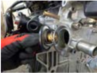
۲- ترموستات معیوب خارج شود.
