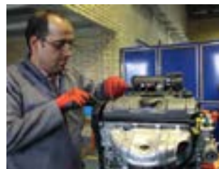
شکل ۳۳-۸- تنظیم پیچ و مهره‌ای خلاصی سوپاپ‌ها
