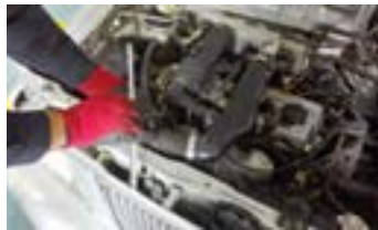
۲- شمع های موتور باز شود.
