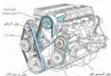
انتقال توان به تجهیزات جانبی با کمک چند تسمه
