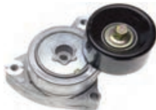
تسمه سفت‌کن اتوماتیک
