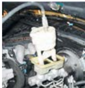
شکل ۱۶-۶- پر کردن و هواگیری سیستم هیدرولیک ترمز به وسیله دستگاه تزریق تحت فشار
