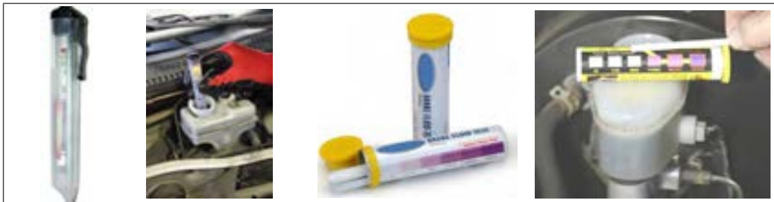
شکل ۶-۷- تست کیفیت مایع هیدرولیک ترمز
