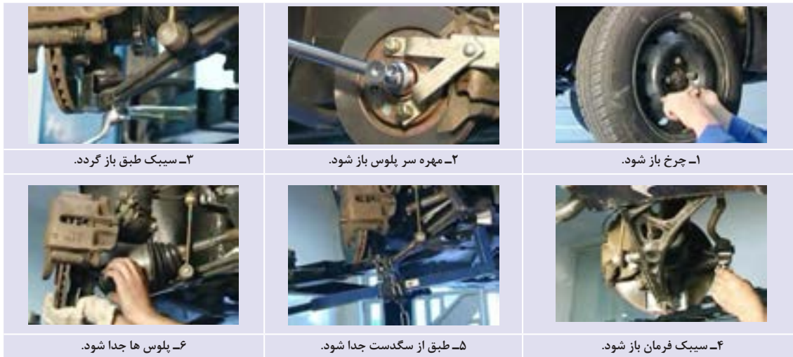
شکل ۹-۹- نحوه بازکردن پلوس
