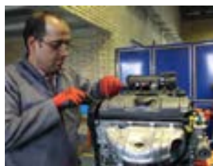
شکل ۳۳-۸- تنظیم پیچ و مهره‌ای خلاصی سوپاپ‌ها
