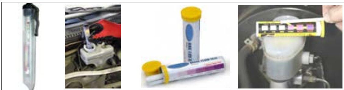
شکل ۶-۷- تست کیفیت مایع هیدرولیک ترمز
