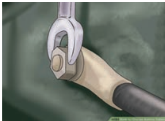
شکل ۱۴-۹- اتصال منفی یا اتصال بدنه قسمت موتور
