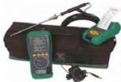
شکل ۸-۲۰- دستگاه آنالیز گازهای خروجی اگزوز
