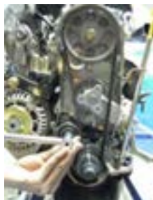
۸- کشش تسمه توسط تسمه سفت کن تنظیم گردد. و موتور دو دور جهت بررسی مجدد کشش تسمه، چرخانده شود.
