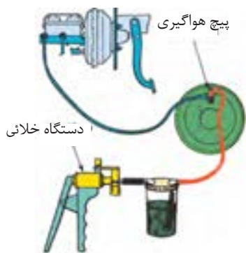
شکل ۱۵-۶- پر کردن و هواگیری مدار هیدرولیک ترمز به وسیله دستگاه خلائی
