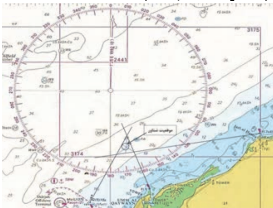
شکل ۶- تعیین موقعیت با استفاده از سه سمت
