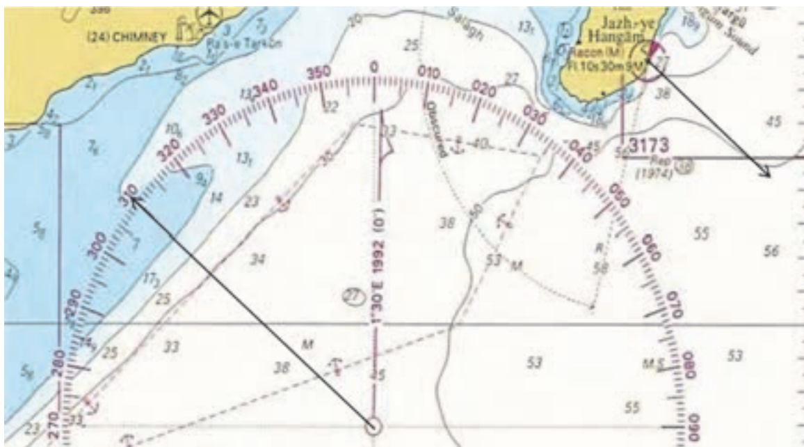
شکل ۵- روش ترسیم سمت یک شیء روی نقشه
