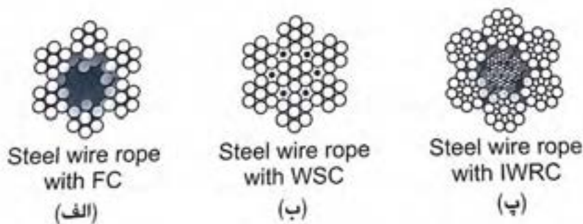
شکل ۱۶- انواع مغزه و نحوه استقرار آنها در طناب‌های سیمی
