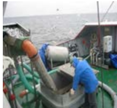
شکل ۱۵- جابه‌جایی ماهیان ریز با پمپ‌های مکند و نوار نقاله در شناورهای مجهز
