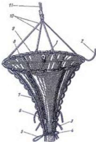
شکل ۴۲- اجزا و متعلقات یک تور قیفی (۱- لامپ، ۲- کابل برق، ۳- طناب کوتاه کمربندی، ۴- حلقه‌های فلزی، ۵- طناب بستن ته تور، ۶- وزنه یا زنجیر، ۷- طناب طولی تقویت کننده بدنه تور، ۸- طناب‌های صلیبی، ۹- حلقه فلزی دهانه تور (قاب فلزی)، ۱۰- طناب‌های نگهدارنده تور، ۱۱- کابل وینچ
