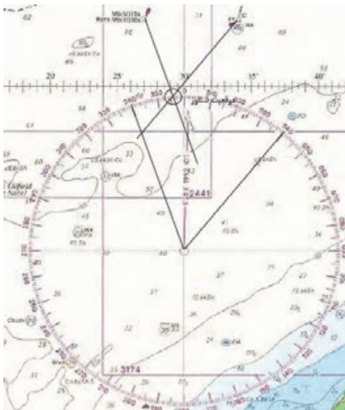
شکل ۷- روش تعیین موقعیت شناور با استفاده از دو خط سمت
