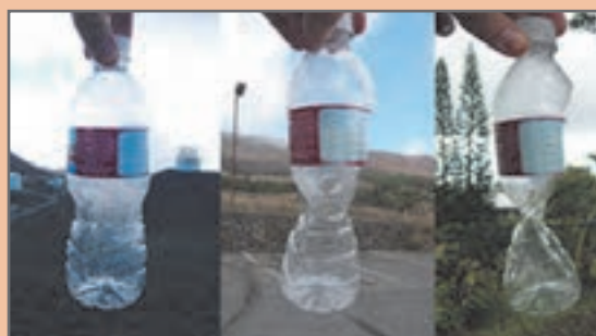
شکل ۴- بطری خالی پلمب شده در ارتفاع ۳۰۰ و ۲۷۰۰ و ۴۳۰۰ متری از سطح دریا
