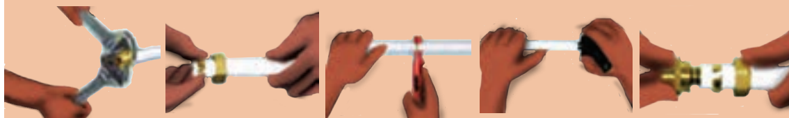
شکل ۴۴- مراحل اتصال لوله پکس
