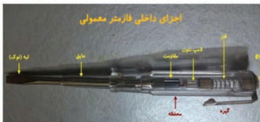
شکل ۲-۳۷- ساختمان داخلی فازمتر
