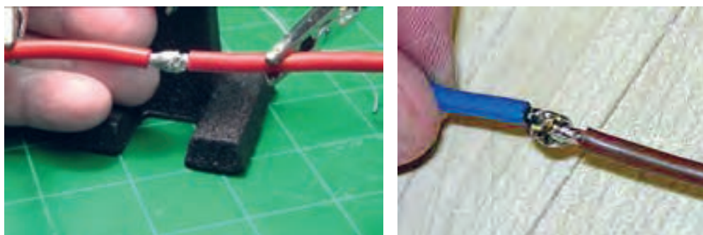
شکل ۵۳-۱ - اتصال دو رشته سیم افشان
