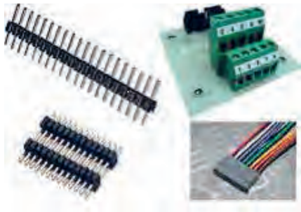
شکل ۱-۷۵ - انواع پین هدر و سوکت مادگی آن
