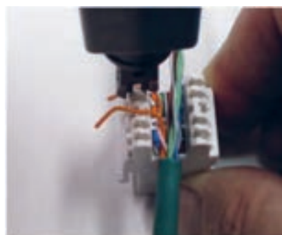
شکل ۱۹-۲- استفاده از یک نوع دستگاه پرچ
