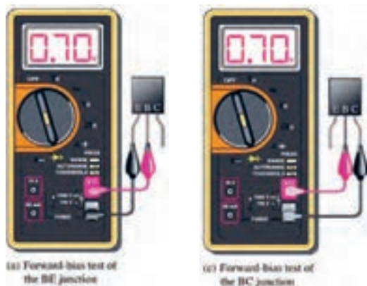
شکل ۴-۳- تشخیص پایه بیس ترانزیستور با مولتی‌متر دیجیتالی
