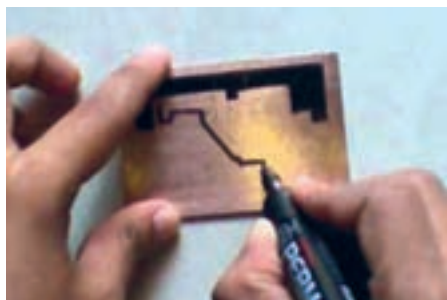
شکل ۲۱-۵- طرح مدار چاپی انتقال داده شده روی فیبر با ماژیک
