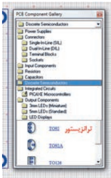
شکل ۴۹-۶- انتخاب پایه‌های ترانزیستور BC547
