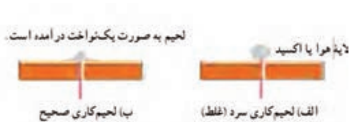
شکل ۵۰-۱- لحیم‌کاری صحیح و غلط
