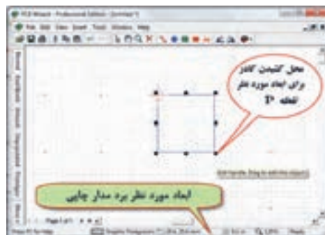
شکل ۳۸-۶- نحوه تعیین اندازه برد مدار چاپی
