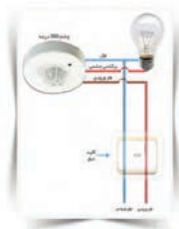
شکل ۲-۷۱- یک نمونه نقشه رله چشمی راه پله
