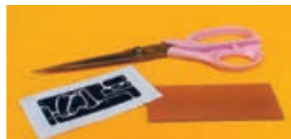
شکل ۷-۷- برش طرح مدار چاپی از کاغذ
