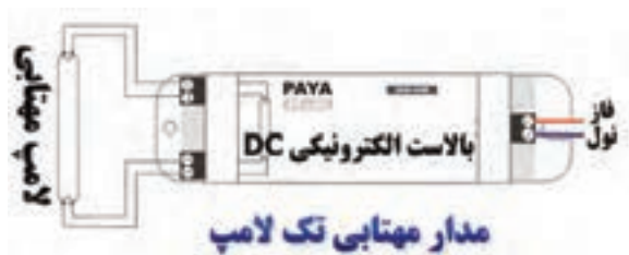
شکل ۶۱-۲- لامپ فلورسنت با انواع بالاست
