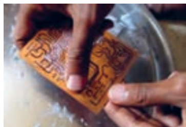
شکل ۱۱-۷- جدا کردن کاغذ از سطح روی فیبر
