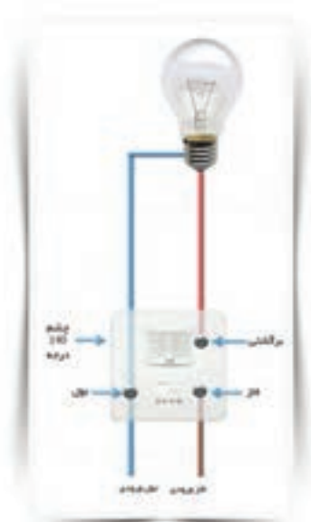
شکل ۲-۷۰- نمونه واقعی اتصال رله راه پله
