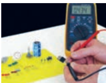
شکل ۷-۳- اطمینان از سالم بودن قطعات
