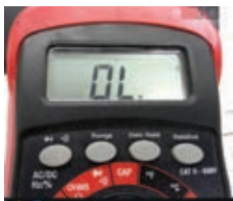
شکل ۳-۶- وضعیت تست دیود در بایاس موافق
