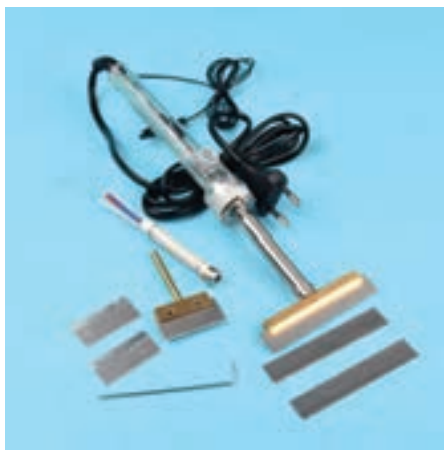
شکل ۴۰-۱- یک نمونه هویه با نوک پارویی
