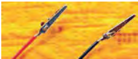
شکل ۶۹-۱ - لحیم کاری گیره سوسماری
