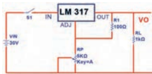
شکل ۸۲-۳- مدار آزمایش با آی سی رگولاتور متغیر
