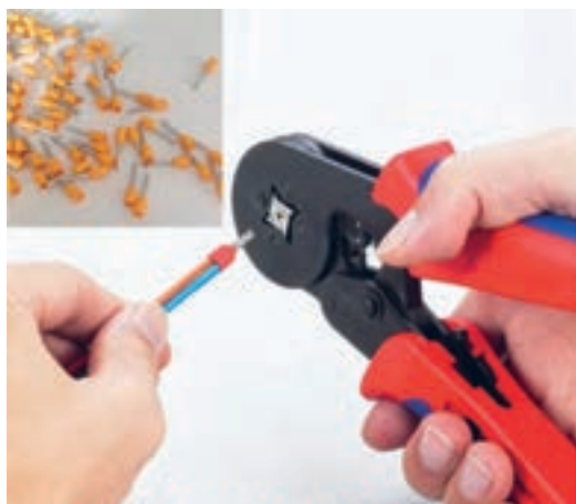
شکل ۶-۲ - دستگاه پرس سرسیم‌های پرسی
