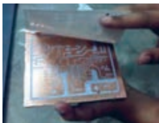
شکل ۱۱-۷- جدا کردن کاغذ از سطح روی فیبر
