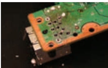
ب- برداشتن لحیمها و آزاد کردن پایهها
