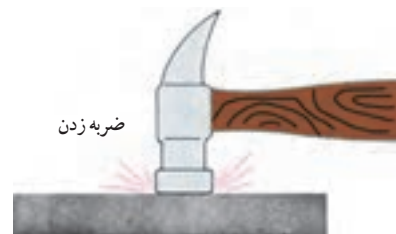
شکل ۸-۷ - خنثی کردن اثر مغناطیس آهن‌ریا با زدن ضربه
