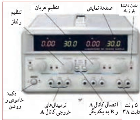
شکل ۸۶- ۱- یک نمونه دستگاه منبع تغذیه
