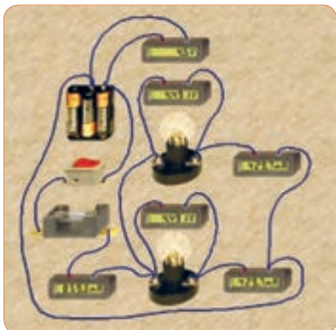
شکل ۷۴-۱- مدار موازی دو لامپ در نرم افزار ادیسون
