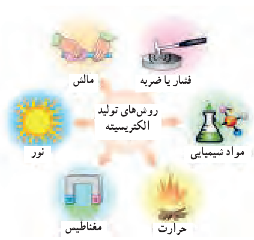
شکل ۲۶ - ۱- روش‌های تولید الکتریسیته
