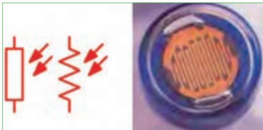
شکل ۹۵-۱- مقاومت تابع نور و نماد آن
