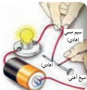
شکل ۱۹-۱- برقراری جریان الکتریکی در هادی
