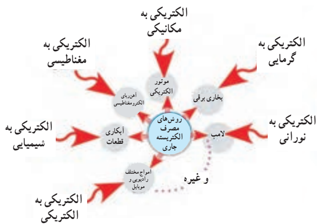
شکل ۲۷ - ۱- روش‌های مصرف الکتریسیته
