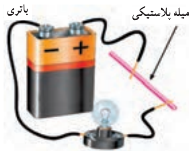
شکل ۲۰ - ۱ برقرار نشدن جریان الکتریکی در عایق
