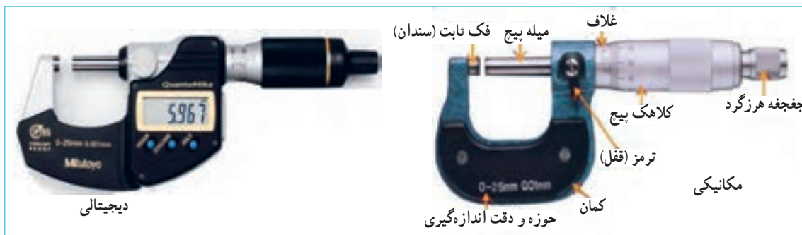
شکل ۱۴-۲- دو نمونه میکرومتر
