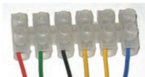
شکل ۱۱-۲- اتصال سیم به ترمینال بلوکی
