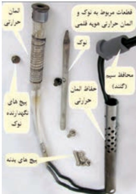
شکل ۹۵-۱ - مراقبت از اجزاء داخلی هویه قلمی
