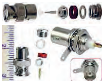
شکل ۱-۷۱- اتصال کابل کوآکسیال به پروب BNC
