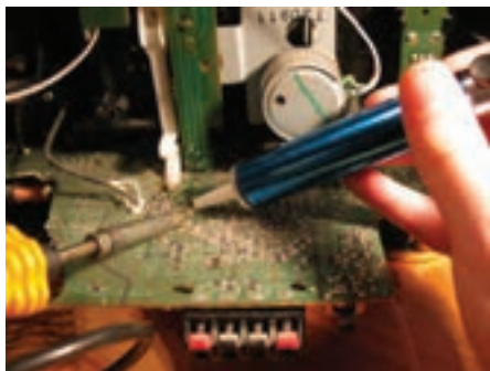
شکل ۸۴-۱- مراحل ذوب شدن و مکش قلع
