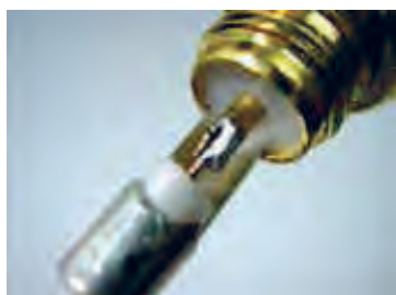
شکل ۱-۷۰- اتصال کابل کوآکسیال به فیش آنتن
