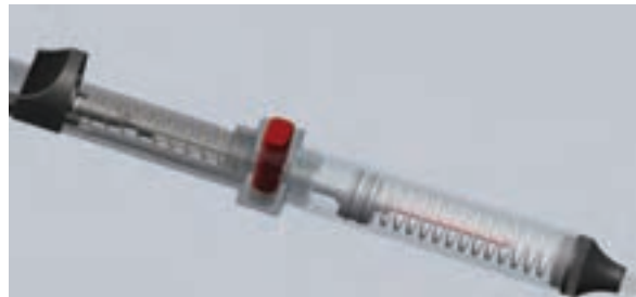
شکل ۸۲-۱- قلع کش پیستونی با روکش شفاف
