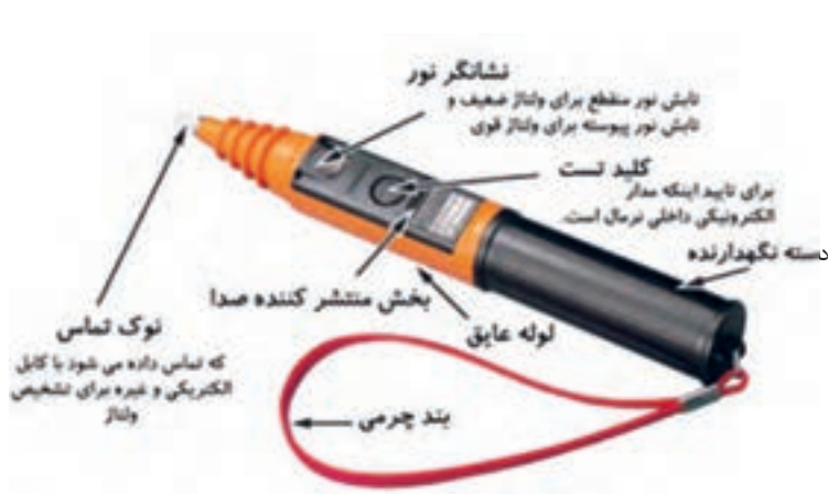
شکل ۳۸-۲- ساختمان داخلی فازمتر دیجیتالی
