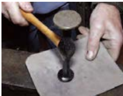
شکل ۲۸-۱- خم کاری روی سندان
