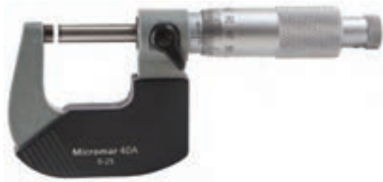
شکل ۱۴- اندازه‌گیری قطر اجسام با میکرومتر
