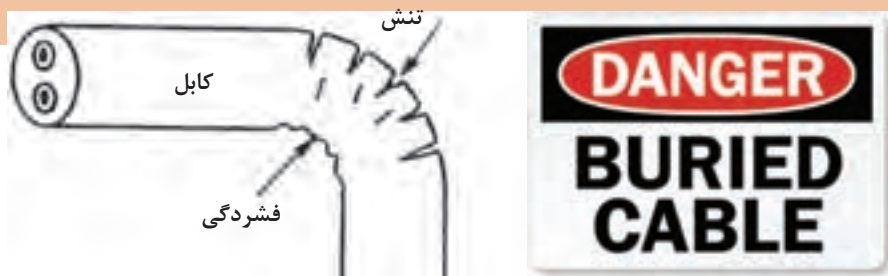
شکل ۲۳- تنش فشردگی خمش کابل
