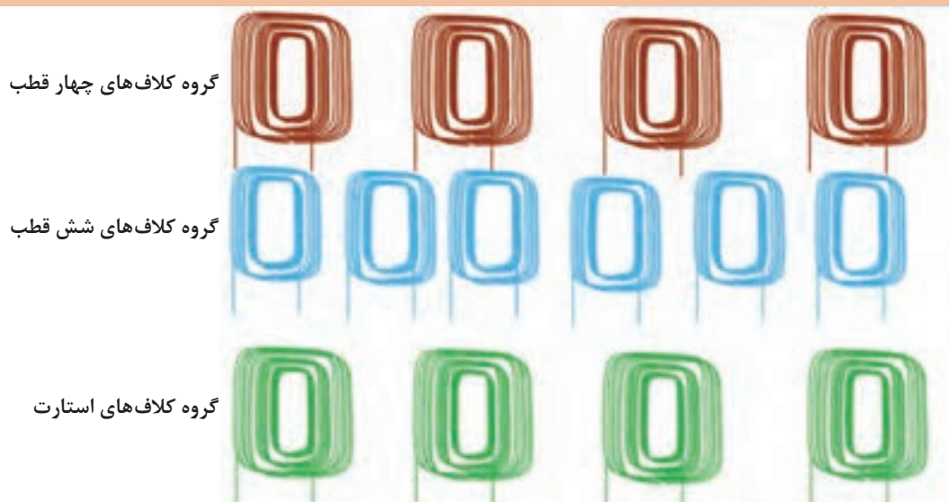
شکل ۴۷- تهیه گروه کلاف های سیم پیچی
