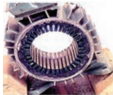
شکل ۲۶- جای‌گذاری گروه کلاف شماره ۱ در شیارهای ۲ به ۸ و ۳ به ۷
