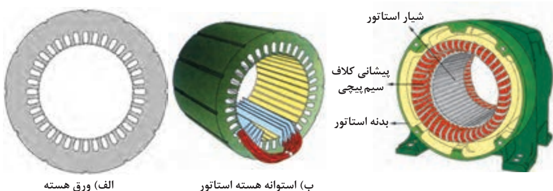
شکل ۴- استاتور سیم پیچی
