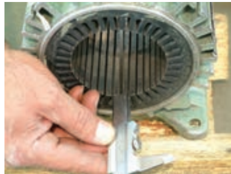
شکل ۲۷- اندازه گیری طول و قطر داخلی استاتور
