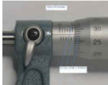
شکل ۱۴- اندازه‌گیری قطر اجسام با میکرومتر
