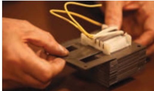
شکل ۳۷- جا زدن هسته
