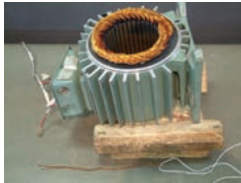
شکل ۳۹- جا زدن سیم پیچ
