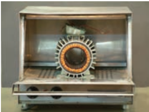
شکل ۲۲- گرم کردن سیم پیچ
