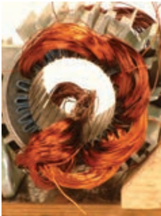
شکل ۶۹- درآوردن بازوهای ۱،۲،۳ برای قرار دادن کلاف آخر
