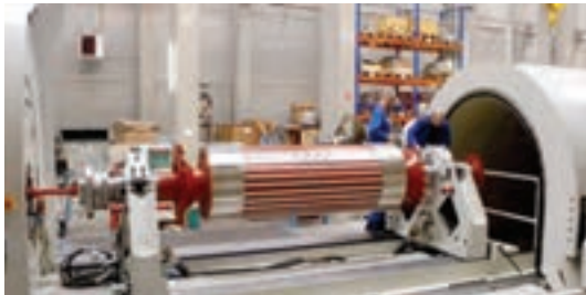
شکل ۵- روتور ژنراتور سنکرون
