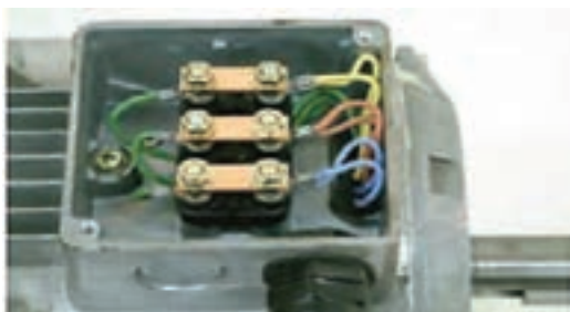
شکل ۴۰- اتصال مثلث موتور
