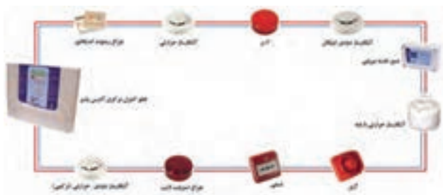
شکل ۳- سیستم اعلام حریق آدرس پذیر
