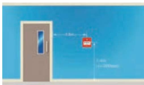
شکل ۲۱- محل و ارتفاع نصب شستی
