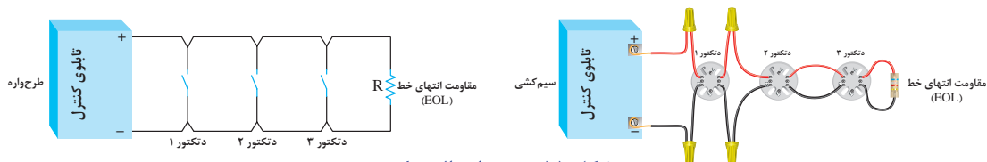
شکل ۵۵- نحوه اتصال دکتور
